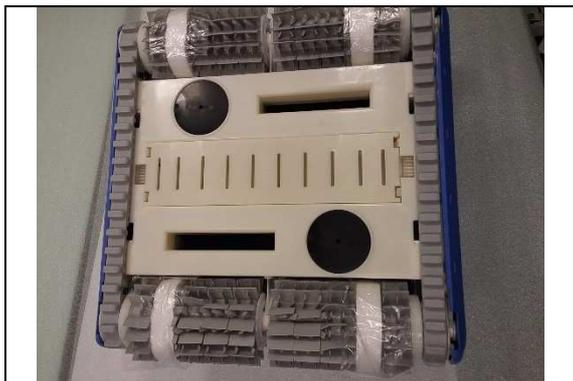
2°STEP: Mediante utensile proporzionato ed adeguato (es. Giravite a taglio 4mm), aprire le linguette elastiche (vedi frecce rosse) e rimuovere il tappo di chiusura vano.
