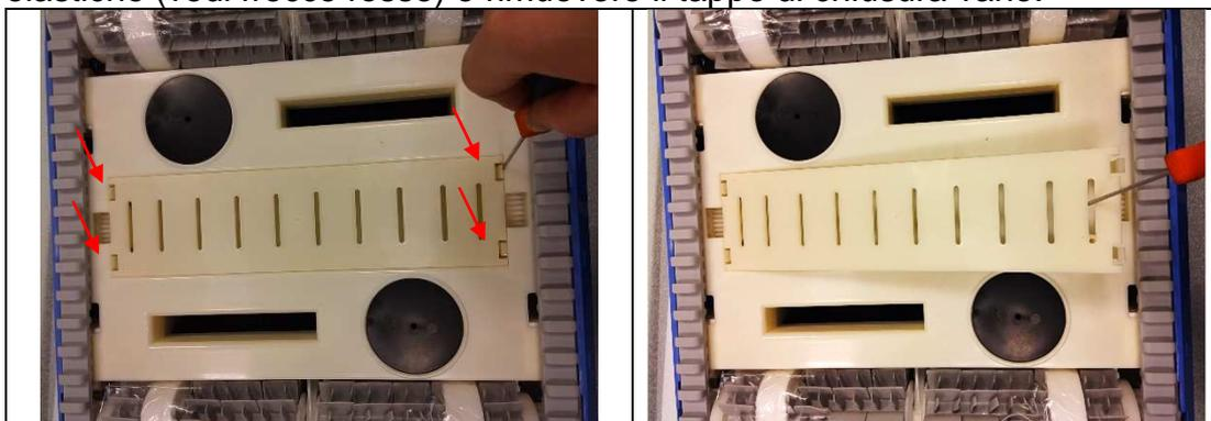
3°STEP: Montare la terza spazzola (esclusivamente u tilizzare il ricambio originale Maytronics) nel vano porta-spazzola, allineando in modo adeguato gli ingranaggi della spazzola.
