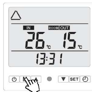
Automatikmodus (Heizen und Kühlen)
