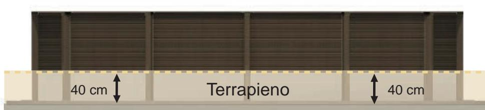
In seguito, realizzare il terrapieno fino a che la base della struttura in acciaio resti completamente coperta (40 cm circa).
