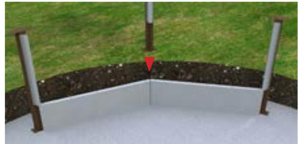
Installare i due pannelli tra i punti **A** e **C** per ottenere il punto esatto su cui installare il sostegno intermedio. Procedere nello stesso modo per ottenere i punti intermedi **D/B**, **B/E**, **F/A**.
