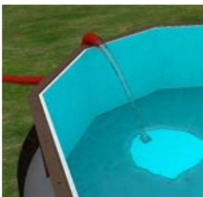
Assicurarsi che il liner sia posizionato perfettamente senza pieghe, se persistono, riempire la vasca con 30 cm d'acqua e nel frattempo aiutarlo a posizionarsi in modo corretto. Arrivati al livello d'acqua indicato, smettere di riempire la vasca e posizionare i giunchi di bloccaggio e tutte le flange di tenuta degli accessori.
