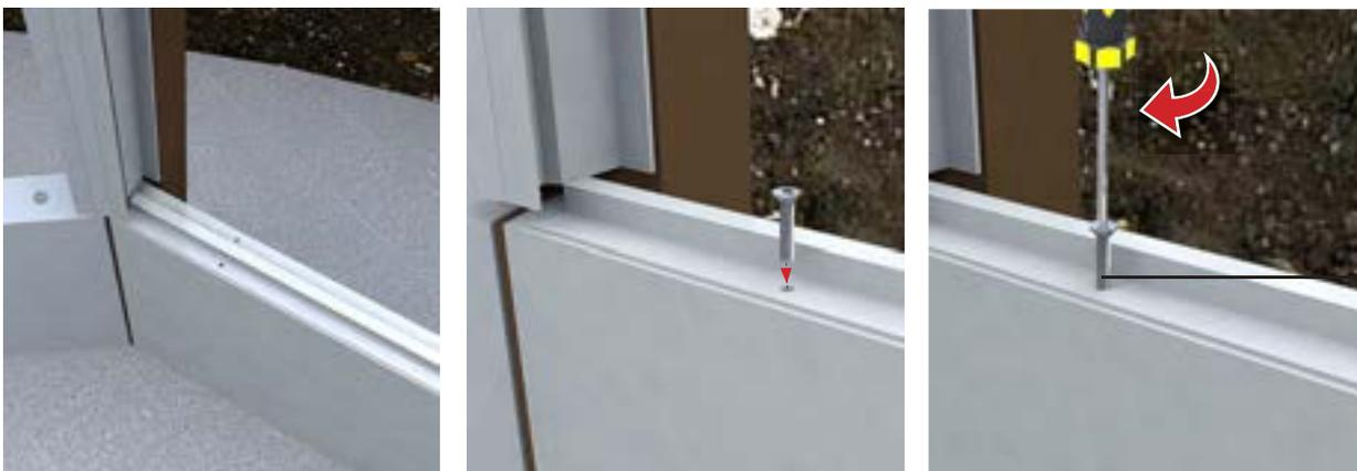
Dopo aver posizionato il profilo di alluminio sulla base di pannelli strutturali, constaterete che la perforazione del profilo è allineata con quella esistente sulla parte superiore del pannello. Utilizzare queste perforazioni per fissare il profilo alla struttura di base utilizzando le viti fornite nel kit.
