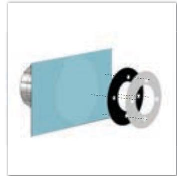
Sovrapporre poi la flangia sulla guarnizione e una volta effettuato il primo buco, avvitare la prima vite. Dopo aver avvitato la seconda, tutte le altre si troveranno nella posizione corretta.
