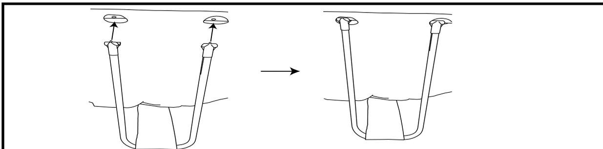
Individuare i fori con un lato sull'asta orizzontale. Posizionare e bloccare i giunti a T nei fori. Assicurarsi che siano completamente collegati.
