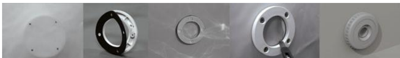
Figure 29 - Montage de la bride sur le corps de refoulement
