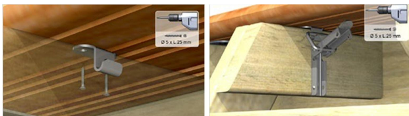
Figure 38 – Montage du système crochet – grenouillère
