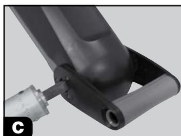
**C** Presentare il ROLLTROT<sup>2</sup> davanti all'uscita quadrata del tubo di avvolgimento. Iniziare l'inserimento con una leggera pressione sul pulsante del telecomando, poi inserire fino in fondo.
