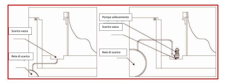
1. Se la rete di scarico si trova ad un livello più basso dello scarico della vasca, si può collegare lo scarico della vasca direttamente alla rete generale. Se la rete di scarico è al di sopra dello scarico della vasca, è necessario utilizzare una pompa di sollevamento. La vasca possiede le griglie laterali, le tubazioni di scarico delle griglie devono essere collegate alla rete di scarico.
