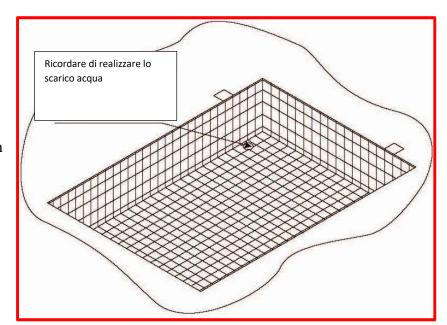
3. Eseguire il getto di cememnto. Livellare la superifice, realizzare il canale di scolo, prevedere i punti di installazione delle tubazioni acqua ed i collegamenti elettrici.
