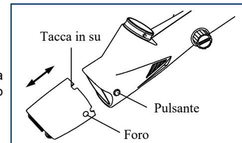
2. Spazzatura nel sacco filtro: con una mano tenere il corpo e girarlo in senso orario, e con l'altra mano rimuovere il sacco filtro. Pulire e rimontare il sacco filtro girandolo in senso antiorario.
