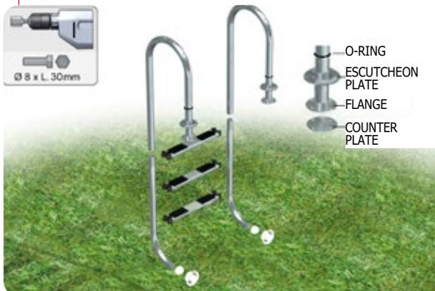
► Assemblare le varie parti della scaletta in acciaio inossidabile riferendosi alle istruzioni d'installazione provviste. Quando montato il corrimano, non dimenticare le due guarnizioni in gomma che saranno usate per tenere in posizione gli stemmi decorativi.
