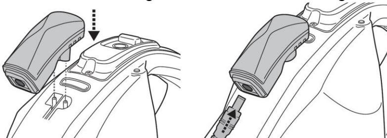
3. Conecte el adaptador externo a la fuente de alimentación. Cuando el limpiafondos empiece a cargarse, el piloto indicador de carga del adaptador externo se pondrá rojo. El indicador LED del adaptador externo se vuelve verde cuando el robot esta completamente cargado. Cárguelo durante 5-6 horas para un rendimiento óptimo.
