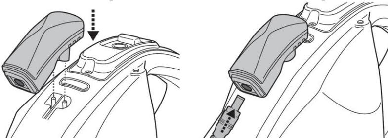
3. Connecter le transformateur à la source d'alimentation. Une fois que le robot commence à charger, le voyant du transformateur devient rouge. Le voyant de l'adaptateur externe devient vert lorsque le robot est chargé. Chargez-le pendant 5-6 heures pour des performances optimales.
