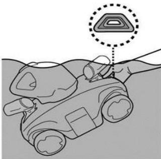
5. Positionner l'interrupteur sur la position OFF. Rincer le robot avec de l'eau fraîche après chaque utilisation. Ne PAS utiliser de détergent.
