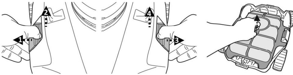
2. Retire la cubierta del filtro y vacíe el compartimento de restos. Se recomienda limpiar la red del filtro con un chorro de agua. Si cree necesario cepillarla, use un cepillo suave para limpiarla con cuidado y evitar daños.
