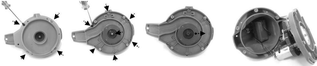
3. Sortir la batterie pour exposer la PCBA. Pour détacher le fil de connexion de la batterie, appuyer sur le clip du connecteur, puis le retirer. **REMARQUE:** Envelopper le connecteur immédiatement avec du ruban isolant afin d'éviter les court-circuits causés par le contact des deux bornes.
