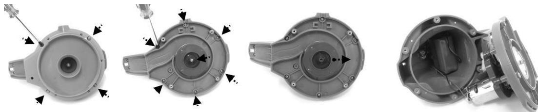
3. Saque el paquete de baterías para dejar el PCBA al descubierto. Para desconectar el cable de la batería, presione el clip del conector y tire de él. **NOTA:** Envuelva inmediatamente el conector con cinta aislante para evitar cortocircuitos causados por el contacto de ambos terminales.
