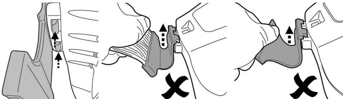
**REMARQUE IMPORTANTE:** Retirer la raclette et la brosse après utilisation. Ceci afin d'éviter une déformation due à un contact constant avec le sol, ce qui pourrait perturber les mouvements du robot.
