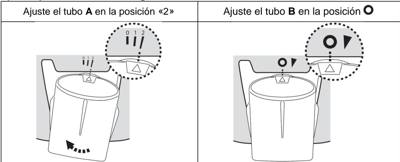
**NOTA:** Si el robot se desplaza describiendo círculos o no cubre la totalidad de la piscina, ajuste el tubo **B** en la posición «**▼**», tal como se ilustra a continuación:
