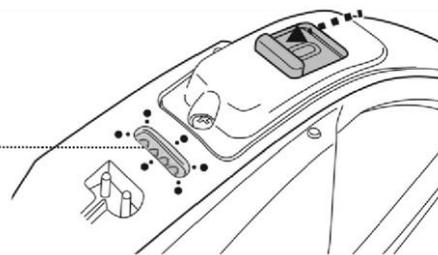
3. Plonger le robot dans l'eau, le moteur se met en marche automatiquement lorsque le niveau d'eau recouvre les capteurs situés en haut de la tête pivotante. Laisser le robot s'enfoncer au fond de la piscine puis observer ses mouvements avant et arrière. Si le robot se déplace le long de la paroi de la piscine plutôt que perpendiculairement, le repositionner en s'assurant que l'avant/arrière fait face à la paroi de la piscine.
