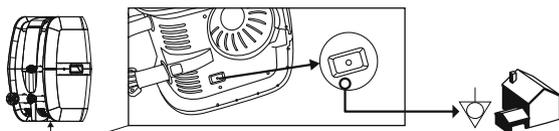
Durante il gonfiaggio, si noterà che l'aria viene espulsa dal punto in cui il tubo dell'aria si collega alla pompa. Ciò rientra nei requisiti tecnici.
