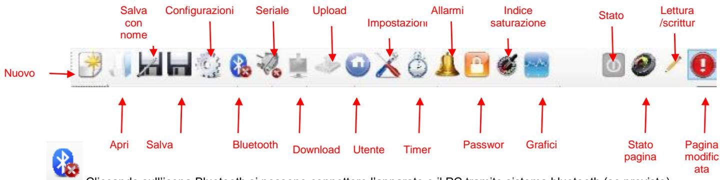
Cliccando sull'icona Bluetooth si possono connettere l'apparato e il PC tramite sistema bluetooth (se previsto). Occorre seguire la seguente procedura per realizzare il collegamento:
