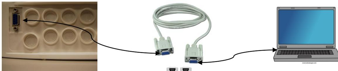
E' anche possibile utilizzare un adattatore RS232→USB se nel PC non è presente una porta seriale. Affinché la comunicazione tra i due dispositivi sia possibile è necessario utilizzare un cavo seriale null modem oppure un cavo seriale dritto con un adattatore null modem. Installare il software che si trova nel cd fornito e avviare l'applicazione cliccando sull'icona presente sul desktop dopo l'installazione.
