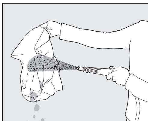
Reinigen Sie den Filterbeutel mit einem Wasserschlauch.
