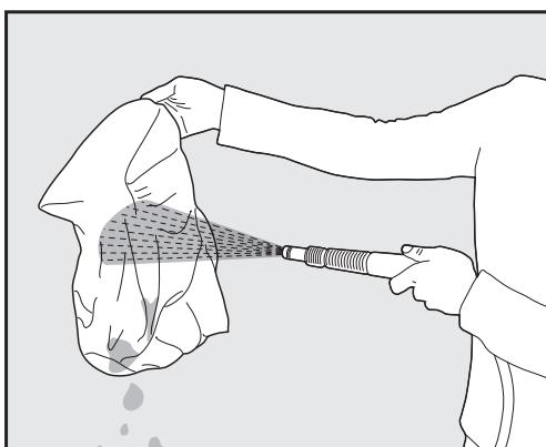
Nettoyez le sac de filtrage à l'aide d'un tuyau d'eau.
