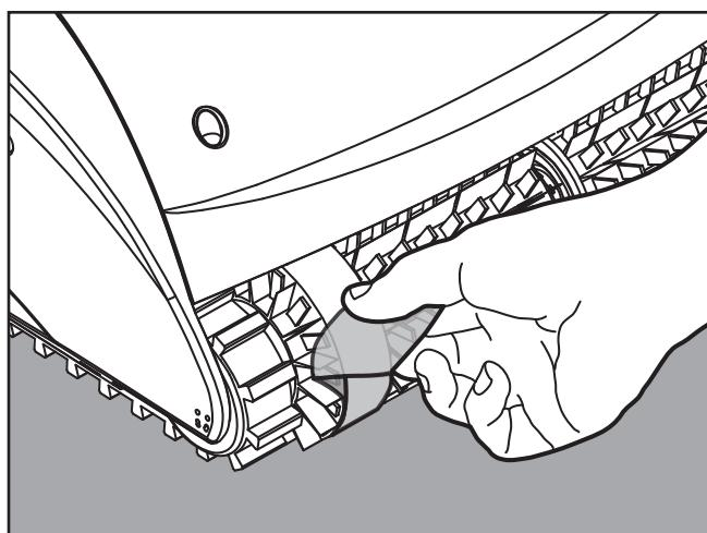
Spingendo in dentro i pulsanti sull'impugnatura, girare l'anello così che la sporgenza più prominente sull'anello è allineata con la sporgenza sulla parte centrale del pulitore.
