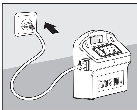
Enchufe la fuente de alimentación y déjela en la posición OFF (apagado).
