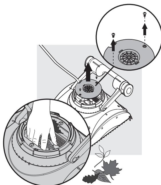
Si nota que hay suciedad atrapada en la turbina, abra la cubierta y extraiga la suciedad.
