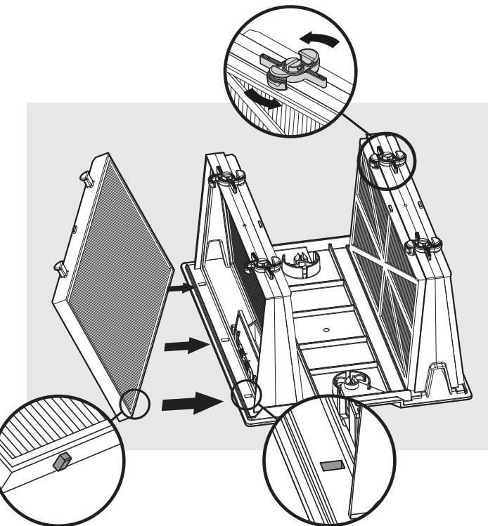
**!** Zusätzlich zu den Standard-Kartuschenfiltern ist der Poolreiniger auch mit Frühjahrs-Reinigungsfiltern ausgestattet, die für die erste Saisonreinigung verwendet werden können oder wenn der Pool außergewöhnlich verschmutzt ist.
