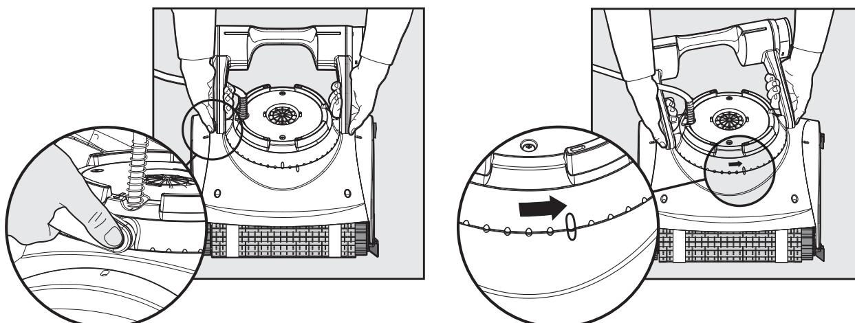
Während Sie den jeweiligen Druckknopf am Schwimmkörper drücken, ziehen Sie diesen vollständig heraus.
