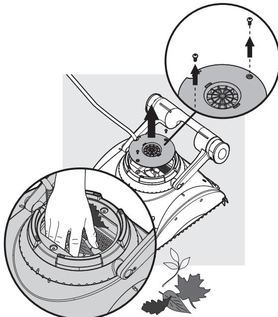
Wenn Sie Steinchen im Flügelrad bemerken, die sich verklemmt haben, öffnen Sie das Flügelrad und entfernen die Steinchen.
