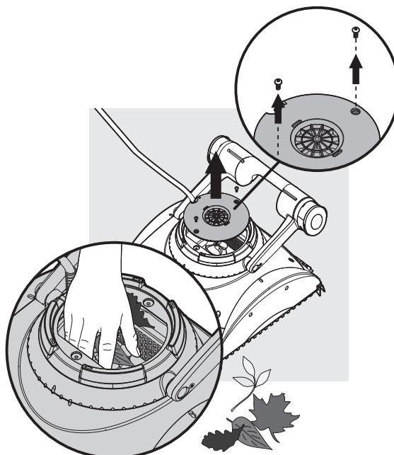
Si vous constatez l'existence de débris emprisonnés dans l'impulseur, ouvrez l'impulseur et retirez les débris.
