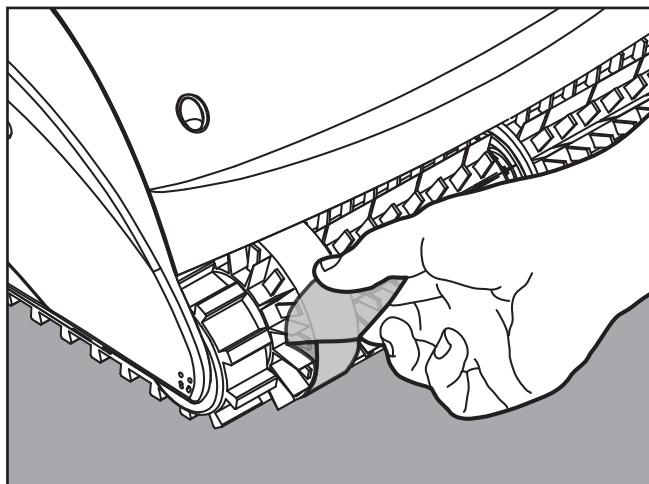
Tout en enfonçant les boutons de la poignée, faites tourner l'anneau de manière à ce que la grande projection de l'anneau s'aligne avec la projection du corps du Nettoyeur de Piscine.
