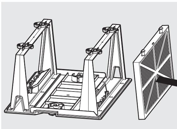
Öffnen Sie die Schnappverschlüsse und entfernen Sie die Filter.
