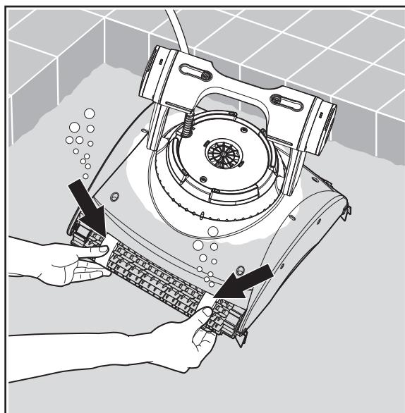
Se il pulitore è dotato di spazzole spugnose, immergerle nell'acqua e strizzarle per renderle in grado di assorbire l'acqua se è la prima volta che il pulitore viene usato o se le spazzole si sono asciugate tra un uso e l'altro.
