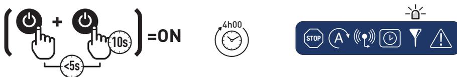
Questa modalità garantisce il flusso d'acqua alla piscina quando la filtrazione principale è spenta (ad esempio, durante il rimessaggio invernale); il pulitore cambia posizione ogni 15 minuti per una durata di 4 ore. Premere una volta il pulsante dell'alimentazione e poi premerlo nuovamente entro 5 secondi, tenendolo premuto per 10 secondi, finché il LED sopra l'icona del filtro non si accende.
