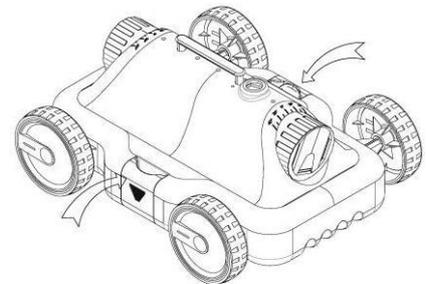
**La sostituzione del filtro vassoio**
