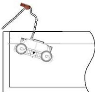
Rilasciare il resto del cavo quando il dispositivo della pulizia è stato abbassato lentamente sul pavimento della piscina.
