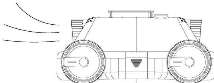
Per alcune piscine specifici, la modalità di spazzamento può essere utilizzata per far saltare in aria i detriti situati in un angolo o particelle fini in modo da raccogliere o filtrarli con il vostro sistema di filtrazione principale piscine.
