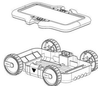
Lavare il cassetto del filtro e il telaio poi rimontare il pulitore
