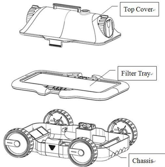
Fare il montaggio del pulitore secondo lo schema di cui sopra
