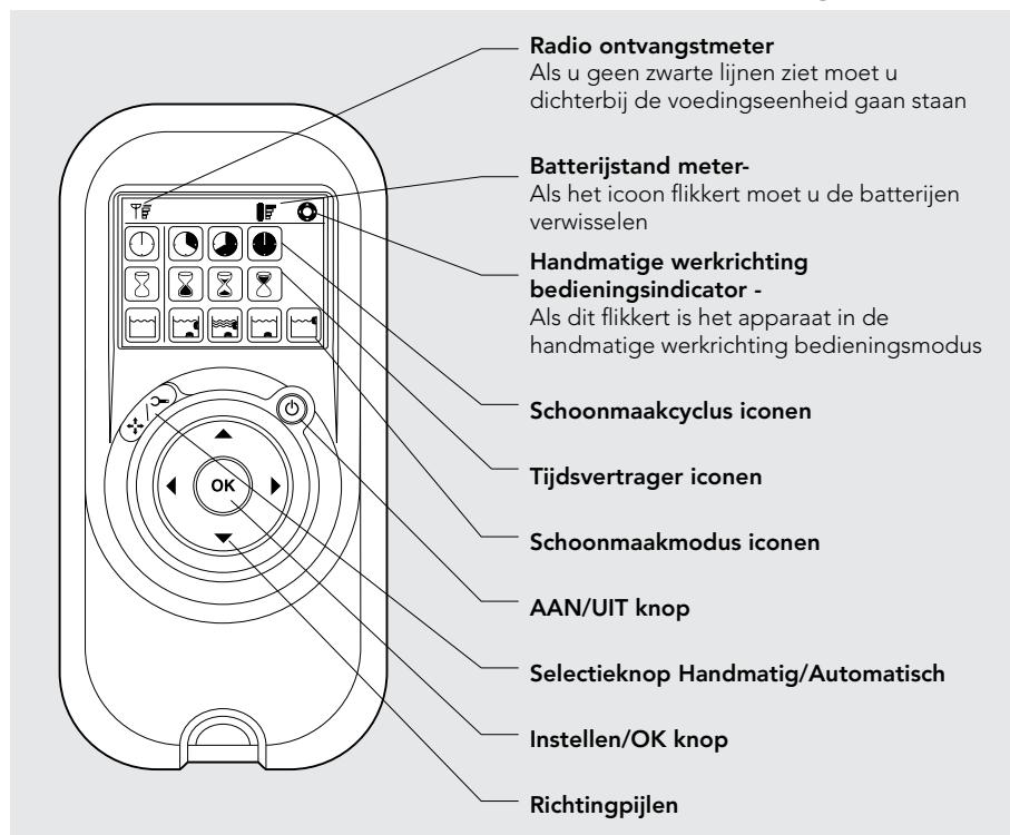
De Afstandsbediening heeft twee werkmodi – de Automatische modus en de Handmatige werkrichting bedieningsmodus.
