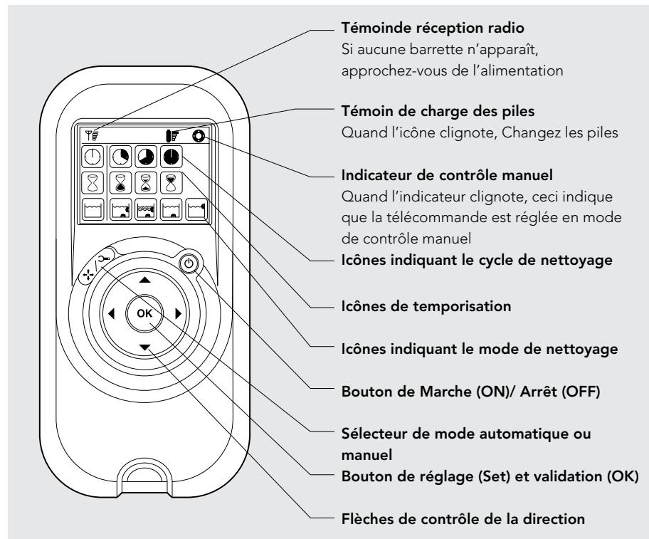
La télécommande dispose de deux modes de fonctionnement – un mode de contrôle automatique et un mode de contrôle manuel de direction.
