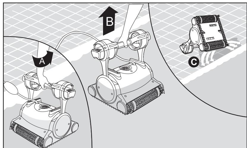
Use el cable flotador para acercar el limpiador hasta el borde de la piscina.
