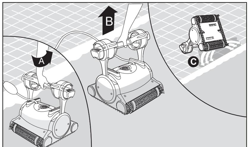
A l'aide du câble de flottaison, ramenez le nettoyeur de piscine au bord de la piscine.
