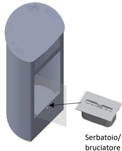
Assicurarsi che l' asta di regolazione (c) sia sempre completamente inserita e aprire lo sportello. Tirare l' asta di regolazione per aprire il serbatoio del combustibile.
