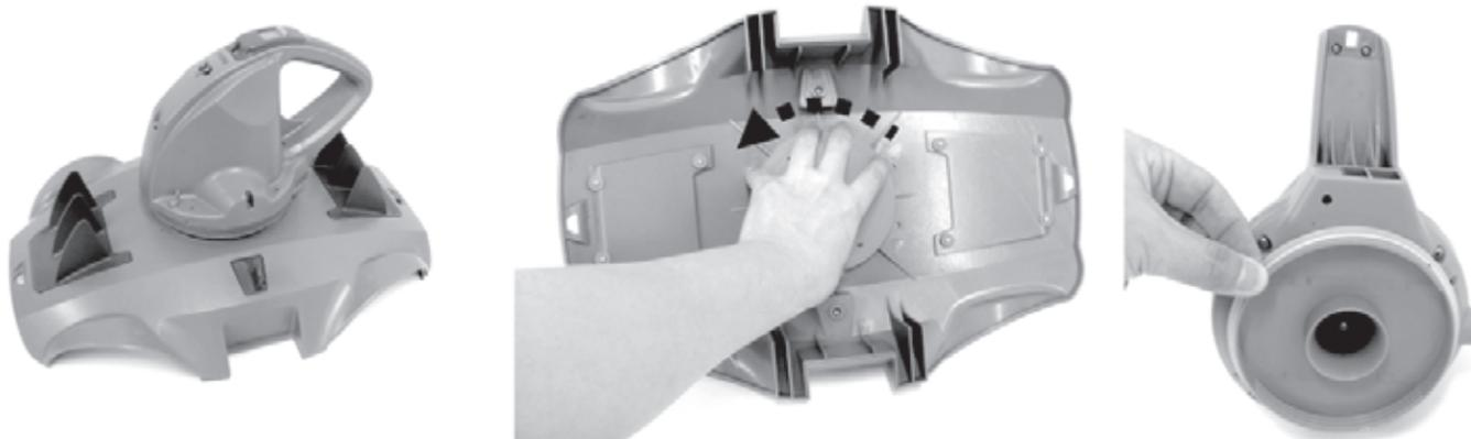
2. Utilize uma chave de parafusos para desaparafusar os 4 parafusos que se encontram no fundo da cabeça para soltar primeiro a placa do fundo. Utilize a chave de parafusos para desaparafusar todos os parafusos na base conforme ilustrado. Remova o impulsor e levante a base e remova-a para expor a cabeça no seu interior.
