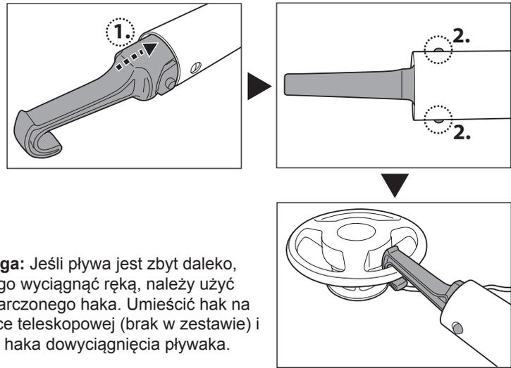
**Uwaga:** Jeśli pływa jest zbyt daleko, aby go wyciągnąć ręką, należy użyć dostarczonego haka. Umieścić hak na tyczce teleskopowej (brak w zestawie) i użyć haka dowyciągnięcia pływaka.
