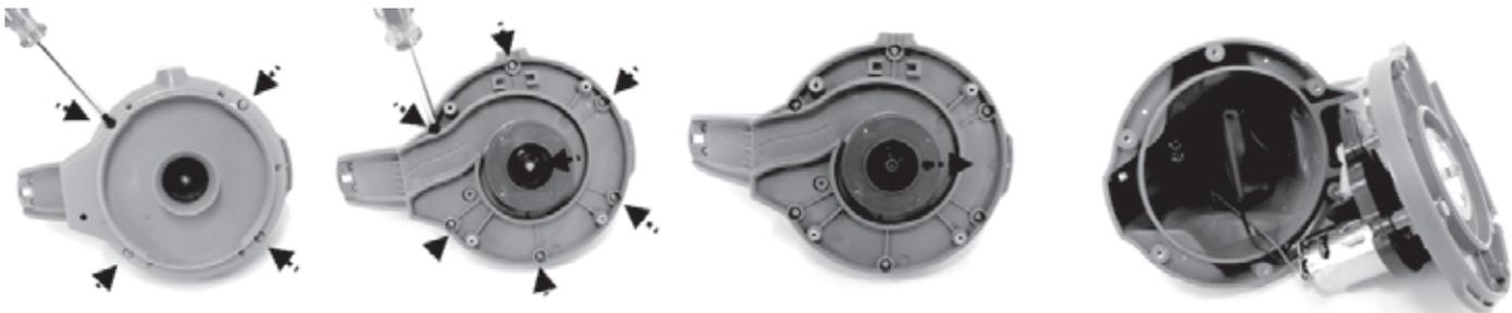
3. Verwijder de batterij om bij de printplaat te kunnen komen. Druk op de clip op de connector en trek die dan naar buiten om de verbindingdraad van de batterij los te maken.
