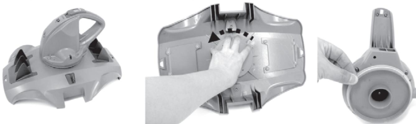
2. Con un cacciavite rimuovere le 4 viti nella parte inferiore della testina, in modo da smontare la piastra alla base. Svitare col cacciavite tutte le viti della base come indicato in figura. Rimuovere la girante, fare leva sulla piastra e rimuoverla, quindi scoprire l'interno.
