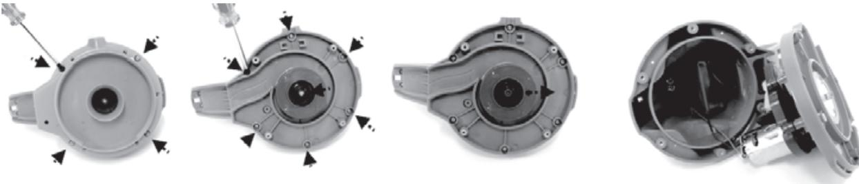
3. Irrota akkuyksikkö. Piirilevy tulee näkyviin. Irrota akun liitinjohto painamalla liittimen klipsiä ja nostamalla akku sitten pois. **HUOMAA:** Kierrä liittimen päähän eristysteippiä, jotta kummankin liittimen koskettaminen ei aiheuta oikosulkuja.
