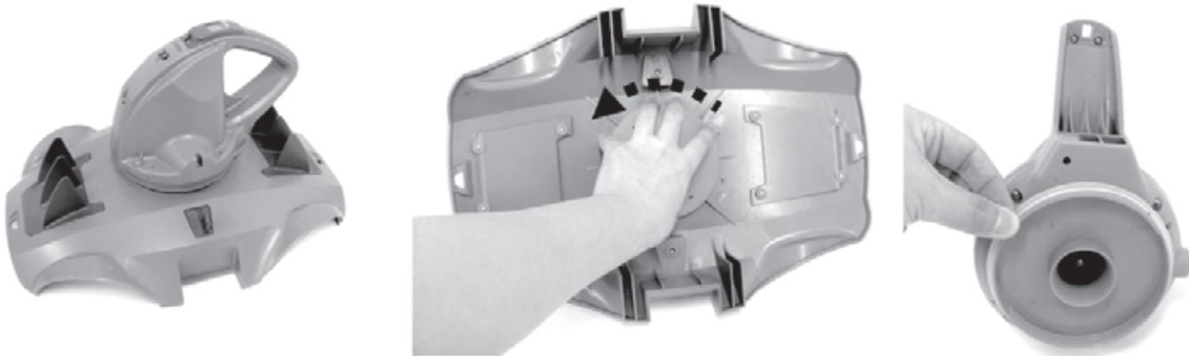
2. Använd skruvmejseln för att skruva loss de fyra skruvarna på undersidan av huvudet för att lossa bottenplattan först. Använd skruvmejseln för att skruva loss alla skruvar på basen enligt bilden. Ta bort impellern och bänd sedan upp basen och ta bort den för att exponera huvudet inuti.
