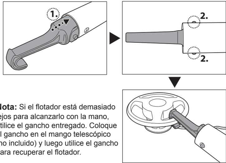
**Nota:** Si el flotador está demasiado lejos para alcanzarlo con la mano, utilice el gancho entregado. Coloque el gancho en el mango telescópico (no incluido) y luego utilice el gancho para recuperar el flotador.
