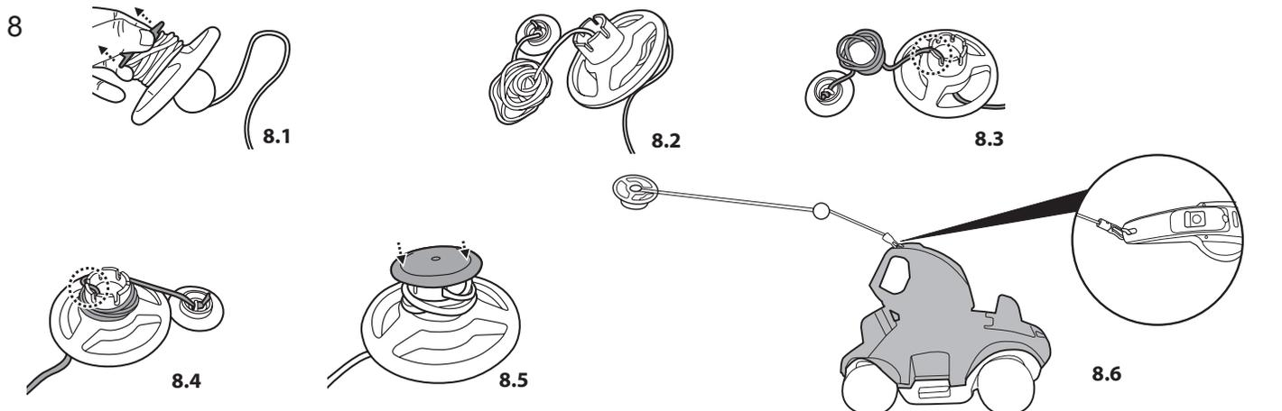
**Uwaga:** Podważyć, aby odłączyć pokrywę pływaką, zwolnić linę z pływaką do głębokości wody basenowej plus około 0,5 m (19,7”).
