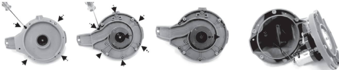
3. Retire el paquete de baterías para dejar a la vista el PCBA. Para soltar el cable de conexión de la batería, presione el clip del conector y luego tire de él hacia afuera.
