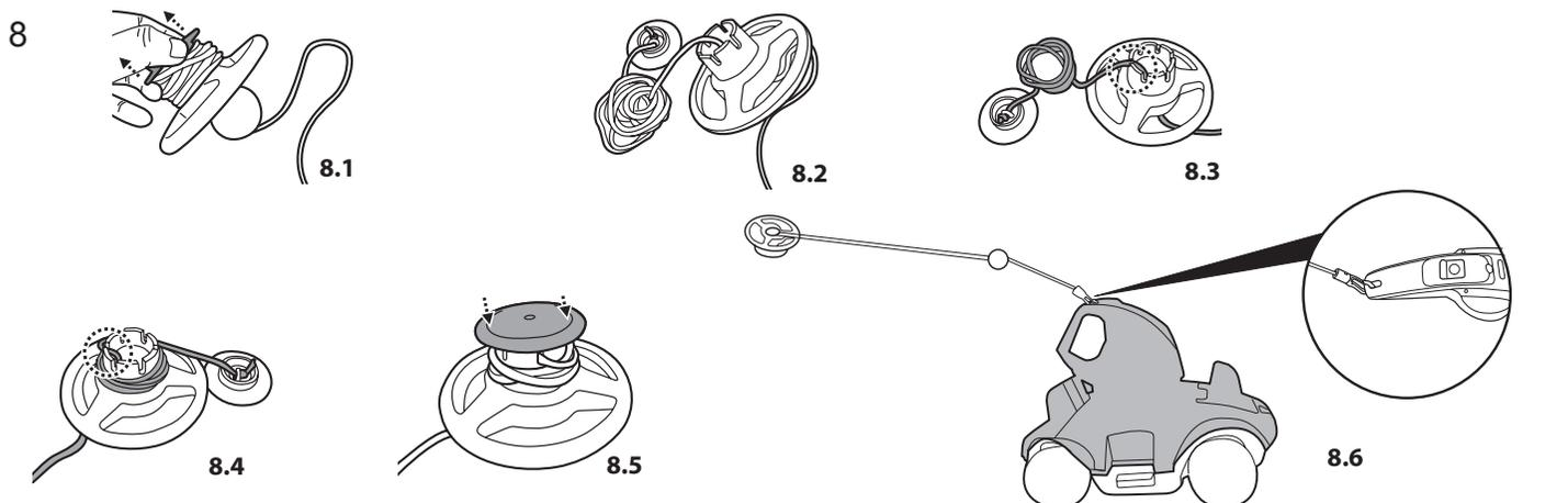
**Hinweis:** Nehmen Sie die Schwimmerabdeckung ab und lassen Sie das Schwimmerseil bis zur Tiefe des Poolwassers ab, plus circa 0,5 m (19.7in.).
