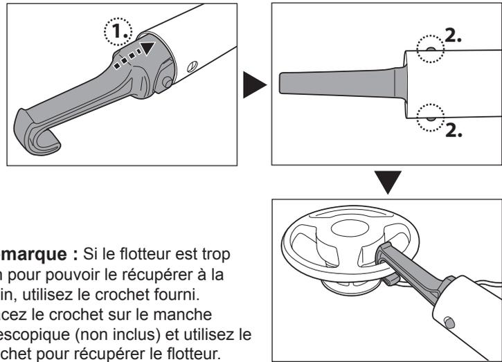
**Remarque :** Si le flotteur est trop loin pour pouvoir le récupérer à la main, utilisez le crochet fourni. Placez le crochet sur le manche télescopique (non inclus) et utilisez le crochet pour récupérer le flotteur.
