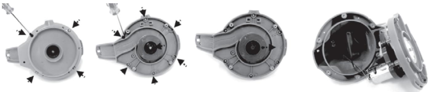
3. Ta bort batteripaketet så att PCBA exponeras. För att lossa batterikabeln trycker du på låsningen på kontakten och drar sedan ut det. **OBS:** Linda omgående ett isoleringsband runt kontakten för att undvika kortslutning som orsakas av kontakten av de båda trådanslutningarna.
