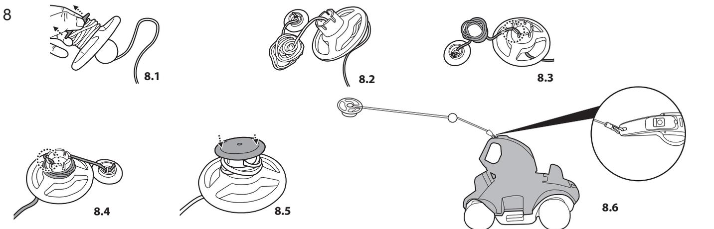
**Nota:** Haga palanca para separar la cubierta del flotador y suelte la cuerda del flotador hasta la profundidad del agua de la piscina, más, aproximadamente, otro medio metro (19,7 pulg.).
