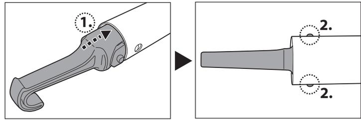
**Hinweis:** Wenn der Schwimmer zu weit entfernt ist, um ihn mit der Hand herauszunehmen, verwenden Sie bitte den beiliegenden Haken. Befestigen Sie den Haken an der Teleskopstange (nicht enthalten) und verwenden Sie den Haken dann, um den Schwimmer herauszunehmen.
