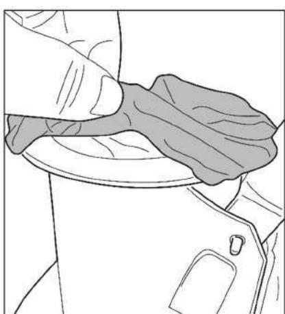
Disposer le sac de filtration sur l'ouverture du haut du corps principal de l'aspirateur. Assurez-vous que le cordon du sac soit placé sous la bride de l'ouverture.
