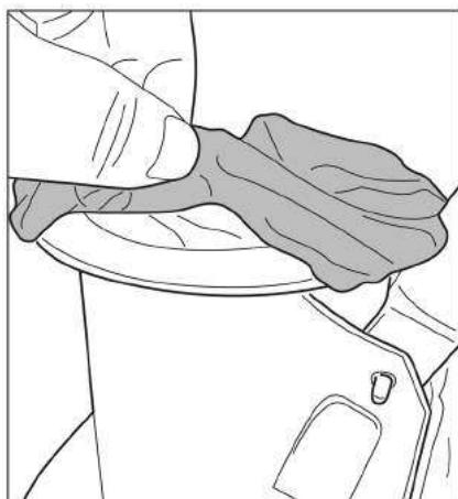
Avaat suodatinpussi allasimurin rungon yläaukon päälle. Varmista, että pussin lanka on yläaukon laipan alla.
