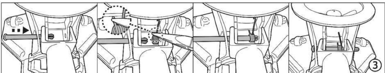
3. Insera o pino a partir de uma extensão e coloque a mola conforme indicado com a ajuda de um alicate. Certifique-se de que o gancho está no topo e que a outra extremidade está instalada debaixo da bancada conforme indicado. Alinhe e insira o pino através do orifício da mola e do orifício oposto.
