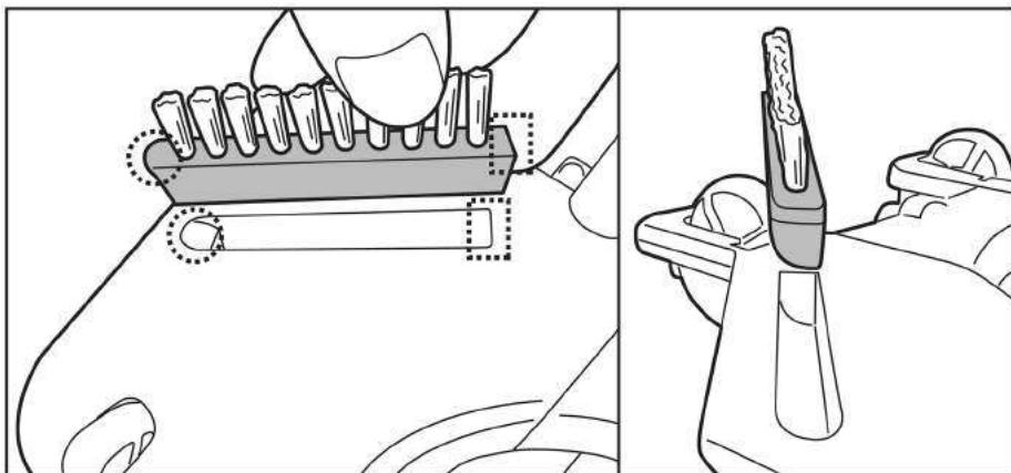
Чтобы снять щетку, вставьте кончик маленькой отвертки в угловую выемку и подденьте щетку.
