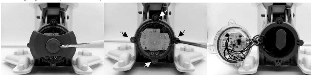
2. Извлеките аккумулятор из устройства и найдите разъем кабеля аккумулятора. Нажмите на зажим разъема, чтобы вытащить его. **ПРИМЕЧАНИЕ:** Немедленно оберните контакты изолентой, чтобы избежать короткого замыкания, вызванного контактом обеих клемм проводов.
