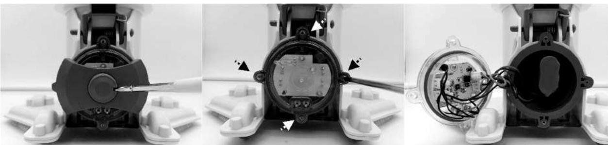
2. Fjern batteriet fra enheten, og finn batteriets kabelkobling. Trykk på klipsen på koblingen for å dra den ut. MERKNAD: Pakk koblingen inn i isolasjonsteip øyeblikkelig, for å unngå kortslutning forårsaket av kontakt med begge ledningsterminalene.
