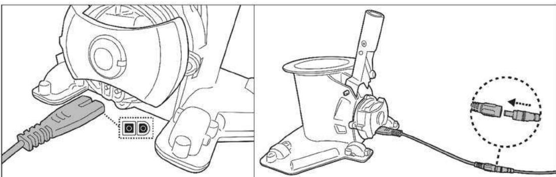
3. Collegare il cavo di ricarica dell'adattatore esterno all'alimentatore. La luce dell'indicatore esterno si accenderà di rosso quando il pulitore è in carica e di verde quando sarà completamente carico. Caricalo per 5- 6 ore per ottenere le migliori prestazioni.
