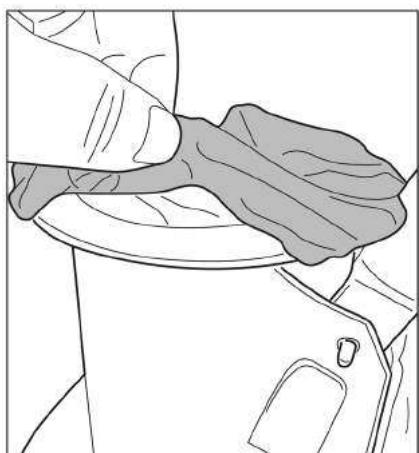
Dra filterpåsen över huvudkroppens övre öppning på pooldammsugaren. Se till att påsens band placeras under öppningens fläns.
