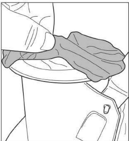
Espalhe o saco do filtro sobre a abertura superior do corpo principal do aspirador de piscinas. Certifique-se de que o cabo do saco é colocado debaixo da flange da abertura superior.
