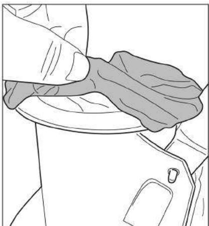
Bre filterposen utover åpningen øverst på hoveddelen av bassengstøvsugeren. Sørg for at snoren på posen er plassert under kanten på åpningen øverst.
