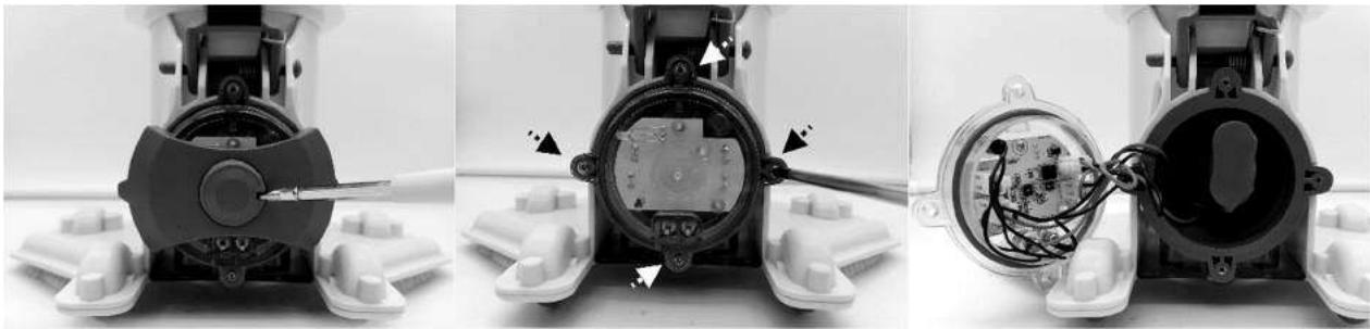
2. Retirez la batterie de l'appareil et localisez le fil de connexion de la batterie. Pour détacher le fil de connexion de la batterie, appuyez sur le clip du connecteur pour le retirer. REMARQUE : Enveloppez immédiatement le connecteur avec du ruban isolant afin d'éviter tout court-circuit provoqué par le contact des deux bornes de fil.
