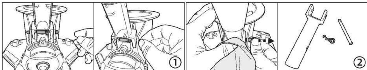
1. Agarre a extremidade superior arredondada do pino. Utilize um alicate para ajudar com a remoção, se necessário.
