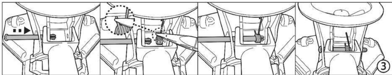
3. Insérez la broche d'un côté et replacez le ressort comme indiqué à l'aide d'une paire de pinces. Assurez-vous que le crochet est placé au-dessus verticalement, et que l'autre côté est placé sous la partie plate indiquée ci-dessus. Alignez et insérez la broche sur toute la distance à travers le trou du ressort jusqu'au trou du côté opposé.
