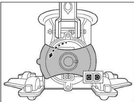
2. Allineare e collegare la cavo di ricarica alla porta di ricarica. ATTENZIONE! Assicurarsi di non invertire la cavo di ricarica e assicurarsi che sia la spina che la porta di ricarica siano pulite e asciutte prima di caricarle. SUGGERIMENTI: usa un batuffolo di cotone per asciugare la porta di charging e i perni. Collegare la spina del cavo dell'adattatore esterno alla porta del cavo di ricarica.
