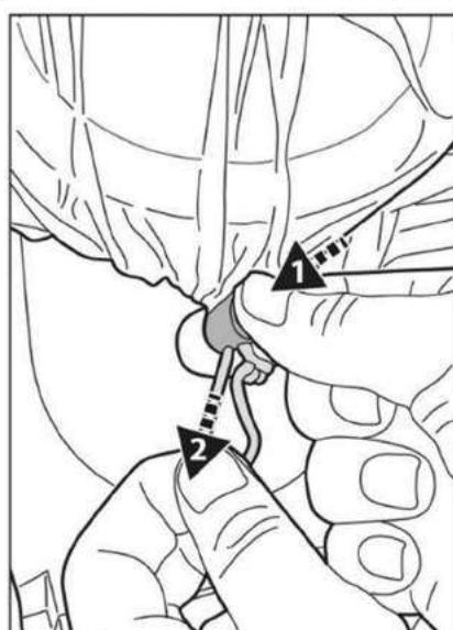
Während Sie die Schnur halten, drücken Sie auf den Schnurbefestigung und schieben Sie ihn unter den Flansch.
