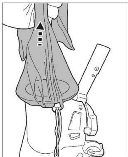
Til de zak op om ervoor te zorgen dat deze volledig is beveiligd voordat u de zwembadstofzuiger in water plaatst.
