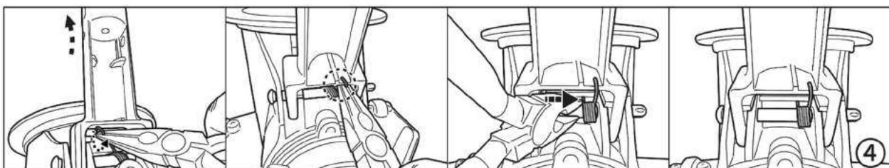
4. Usare un paio di pinze per tirare il gancio dalla parte inferiore della connettore, poi fissarlo sulla connettore come mostrato. Spostare l'intera molla a destra.
