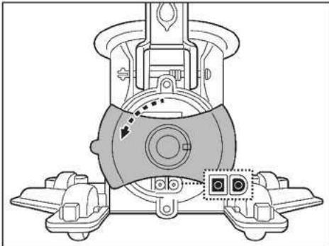
2. Richten Sie den Ladekabel aus und schließen Sie ihn an den Ladeanschluss an. **WARNUNG!** Achten Sie darauf, den Ladekabel nicht umzudrehen und sicherzustellen, dass sowohl der Ladekabel als auch der Ladeanschluss sauber und trocken sind, bevor Sie sie aufladen. TIPPS: Trocknen Sie den Ladeanschluss und die Stifte mit Wattestäbchen. Stecken Verbinden Sie den Kabelstecker des externen Adapters mit dem Anschluss des Ladekabels.
