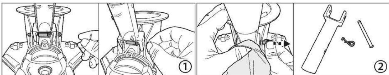
1. Greifen Sie das obere runde Ende des Stifts. Verwenden Sie ggf. eine Zange zur Unterstützung.
