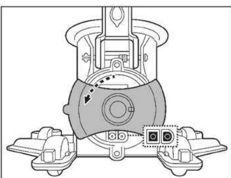
2. Kohdista ja työnnä latauskaapeli latausliittimeen. **VAROITUS!** Älä laita latauskaapelia väärinpäin ja varmista, että sekä latauskaapeli että latausliitin ovat puhtaat ja kuivat ennen lataamista. VINKKI: kuivaa latausliitin ja sen nastat vanupuikolla. Liitä ulkoisen laturin kaapelin pistoke latauskaapelin liittimeen.
