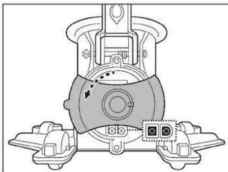
2. Lijn de oplaadkabel uit en sluit deze aan op de oplaadpoort. WAARSCHUWING! Zorg ervoor dat u de laadkabel niet omkeert en zorg ervoor dat zowel de laadkabel als de oplaadpoort schoon en droog zijn voordat u ze oplaadt. TIPS: Gebruik een wattenstaafje om de oplaadpoort en punten te drogen. Sluit de kabelstekker van de externe adapter aan op de poort van de laadkabel.
