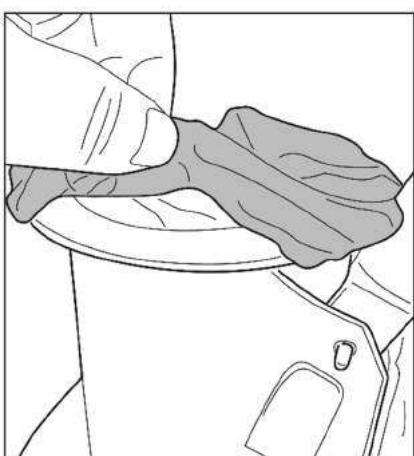
Spreid de filterzak over de bovenste opening van de hoofdbehuizing van de zwembadstofzuiger. Zorg ervoor dat het koord van de zak onder de flens van de bovenste opening is geplaatst.
