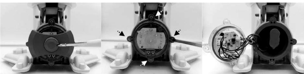
2. Plocka bort batteriet från enheten och lokalisera batterisladdens kontakt. Tryck på kontaktens klämma för att dra ut den. ANMÄRKNING: Linda omedelbart isoleringstejp runt kontakten för att undvika kortslutning orsakad av att de två anslutningsterminalerna kommer i kontakt med varandra.
