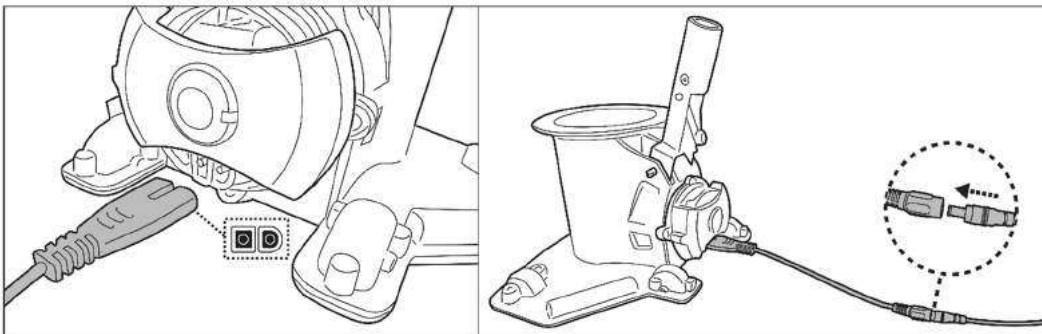
3. Enchufe el adaptador externo a una toma de corriente. El indicador luminoso del adaptador externo permanecerá en rojo mientras la aspiradora se esté cargando y pasará a verde una vez completada la carga. Cargue el aspirador durante 5-6 horas para optimizar su rendimiento.
