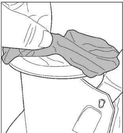
Verteilen Sie den Filterbeutel über der oberen Öffnung des Hauptkörpers des Pool-Saugers. Stellen Sie sicher, dass die Schnur des Beutels unter dem Flansch der oberen Öffnung liegt.
