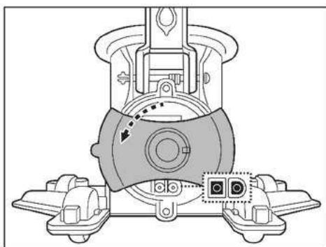
2. Alinee e inserte el cable de carga en el puerto de carga. **ADVERTENCIA:** Asegúrese de no invertir el cable de carga y de que tanto el enchufe como el puerto estén limpios y secos antes de la carga. CONSEJO: Utilice un bastoncillo de algodón para secar el puerto de carga y las clavijas. Conecte el enchufe del cable del adaptador externo al puerto del cable de carga.
