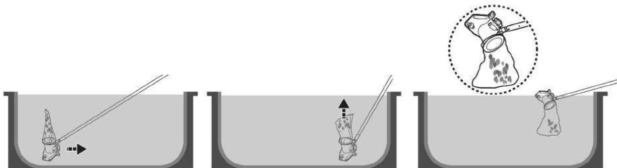
3. Lave o aspirador de piscinas com água fresca após cada utilização. NÃO utilize qualquer detergente agressivo.
