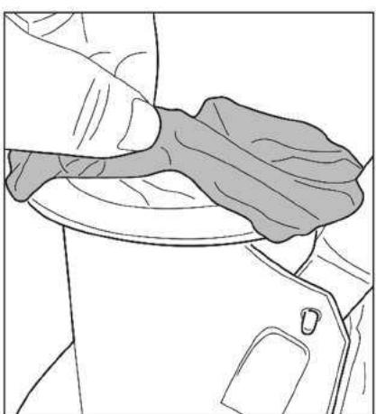
Cubra con la bolsa de filtro la apertura superior del cuerpo principal de la aspiradora de piscina. Asegúrese de que el cordón de la bolsa quede situado por debajo del reborde de la apertura superior
