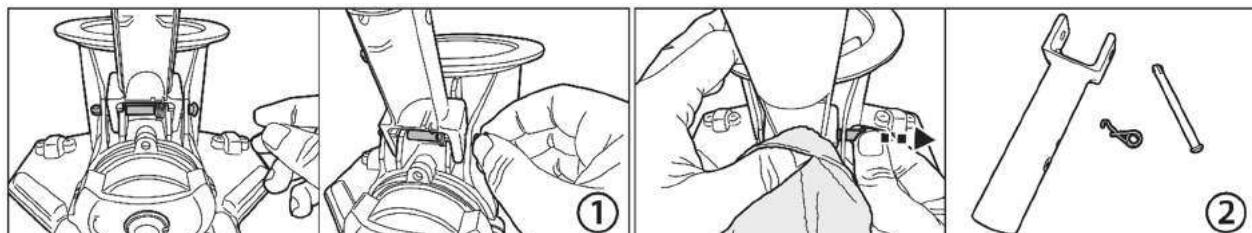
1. Afferrare l'estremità superiore rotonda del perno. Usare un paio di pinze per aiutare la rimozione, se necessario.
