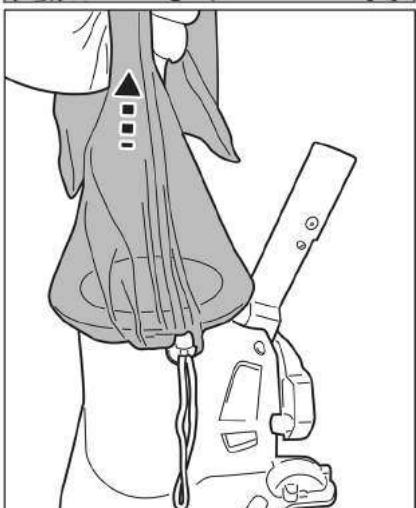
Levante o saco para assegurar que está bem seguro antes de colocar o aspirador de piscinas na água.
