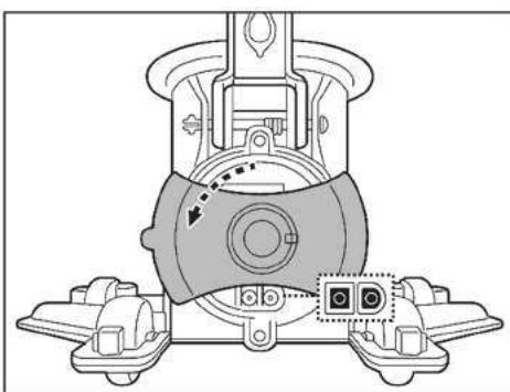
2. Alignez et fixez la câble de charge au port de charge. AVERTISSEMENT ! Veillez à ne pas inverser la câble de charge et assurez-vous que la câble de charge et le port de charge soient propres et secs avant de les brancher. Conseils: Pour sécher le port de charge et les broches, utilisez du coton-tige. Connectez la fiche du câble de l'adaptateur au port du câble de charge.
