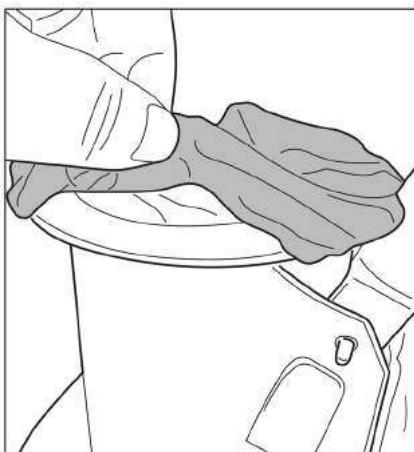
Наденьте фильтр-мешок на верхнее отверстие основного корпуса пылесоса для бассейна. Убедитесь, что шнур мешка находится под выступающим кромкой верхнего отверстия.
