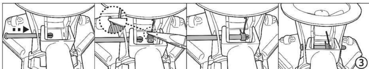
3. Inserire il perno da un'estremità e posizionare la molla come mostrato con l'aiuto di un paio di pinze. Assicuratevi che il gancio sia in alto e che l'altra estremità sia installata sotto il banco come mostrato. Allineare e inserire il perno fino in fondo attraverso il foro della molla e il foro opposto.
