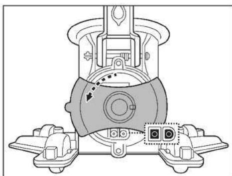
2. Alinhe a anexe o cabo de carregamento com a porta de carregamento. **AVISO!** Certifique-se de que não inverte a cabo de carregamento e que a cabo de carregamento e a porta de carregamento estão limpas e secas antes de as carregar. DICAS: Utilize um cotonete para secar a porta de carregamento e os pinos. Conecte a tomada do cabo do adaptador externo à porta do cabo de carregamento.
