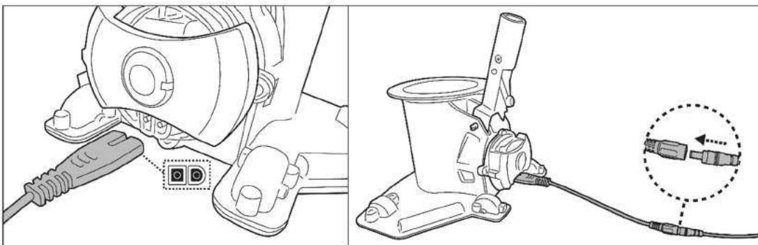
3. одключите внешний адаптер к источнику питания. Индикатор на внешнем адаптере будет красным, пока пылесос заряжается, и станет зеленым, когда пылесос будет полностью заряжен. Для максимальной производительности заряжайте пылесос в течение 5-6 часов.
