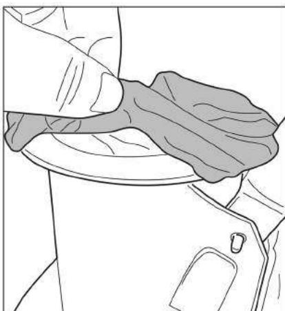
Distribuire il sacchetto filtro sull'apertura superiore del corpo principale del pulitore per piscina. Assicurati che il cavo della borsa sia posizionato sotto la flangia dell'apertura superiore.
