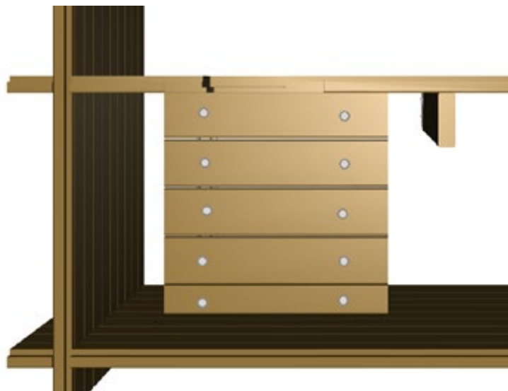
Figura 15 – Instalación del suelo de la caja
