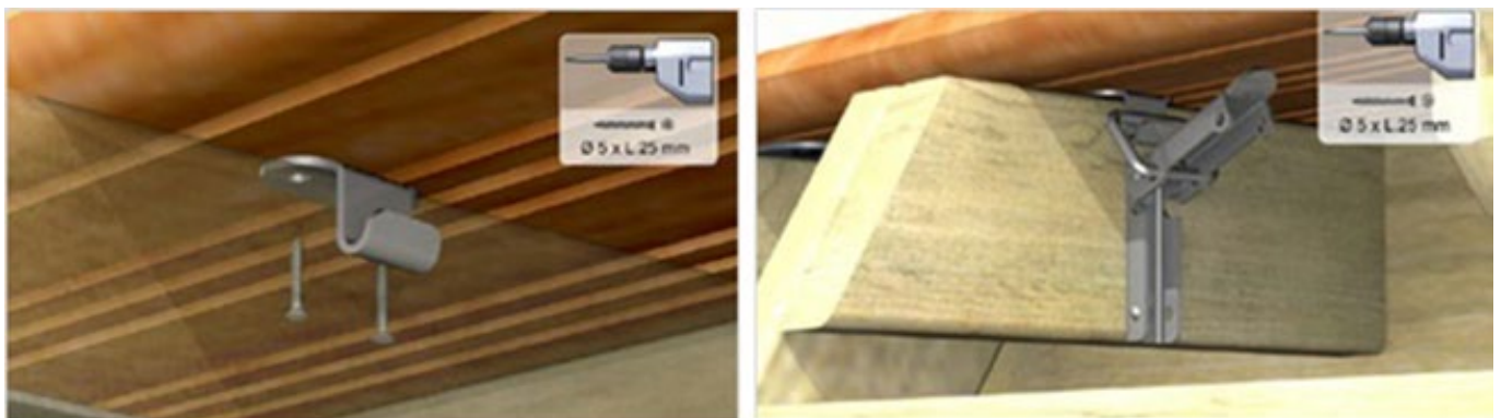
Figure 38 – Montage du système crochet – grenouillère
