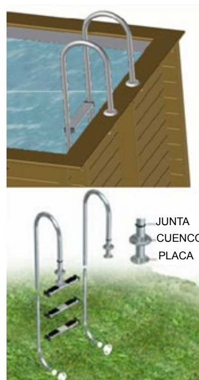
Figura 36 – Instalación de la escalerilla
