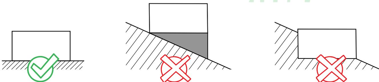
4. Esegui i lavori fondamentali seguendo le linee guida contenute in questo manuale. Ricorda che la preparazione del terreno deve essere effettuata secondo l'arte edilizia. Pianifica anche il tempo necessario per l'asciugatura e l'indurimento del calcestruzzo. La classe del calcestruzzo non deve essere inferiore a C25/30, la classe di esposizione XC2.
