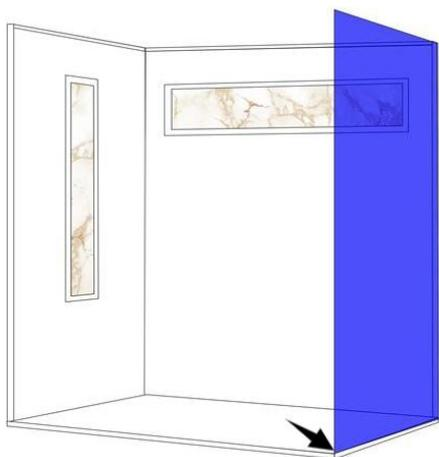
(4) Posizionare la finestra in vetro destro sul pannello del pavimento **Assicuratevi che la finestra sia vicina all'angolo anteriore per evitare spazi vuoti!!!**
