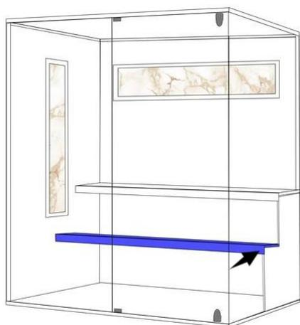
(9) Posizionare la panca inferiore sul pannello di supporto della panca, quindi avvitare la panca inferiore al pannello di supporto della panca nel foro per vite preimpostato.
