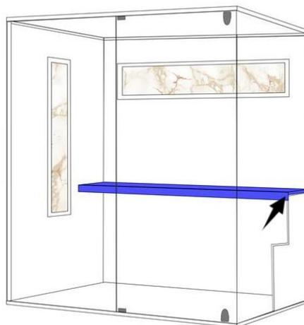
(8) Posizionare la panca superiore sul pannello di supporto della panca, quindi avvitare la panca superiore al pannello di supporto della panca nel foro per vite preimpostato.
