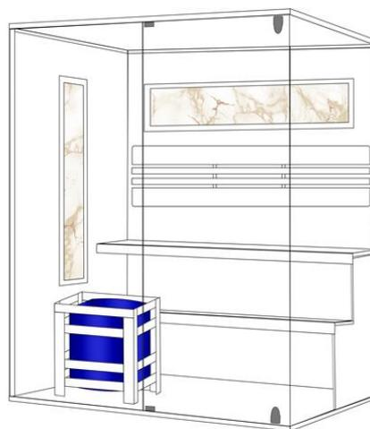
(12) Installare la stufa della sauna sulla recinzione secondo il manuale della sauna
