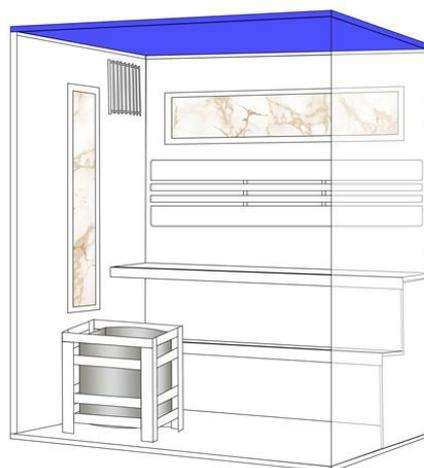
(5) Posizionare il pannello del soffitto sui pannelli installati,
