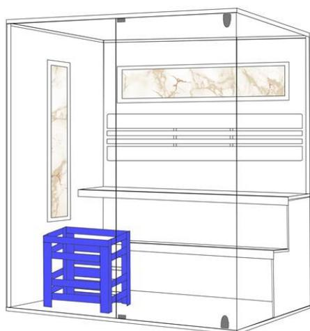
(11) Installare la recinzione della stufa con viti M3.5\*40.
