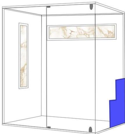
(7) Avvitare il pannello di supporto della panca al pannello del pavimento e al pannello posteriore.
