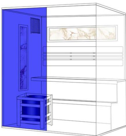
(5) Posizionare il vetro anteriore tra il pannello del pavimento e il pannello del soffitto, quindi installare il vetro destro e il vetro anteriore con i set di viti Deco sul pannello del soffitto e sul pannello del pavimento.
