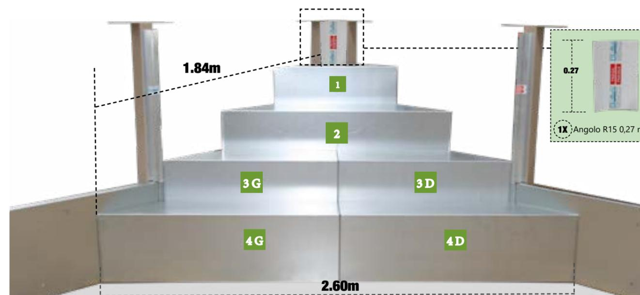
**16** Posizionare l'angolo R15 (0,27 m) e ricontrollare le misure secondo l'immagine. Il pannello bianco deve essere posizionato prima delle traverse in cemento. Se è necessario posizionare questo pannello, alleggerire le viti di fissaggio del piolo 3 e 4 e del puntello C. **Dopo aver completato questa fase, è necessario procedere con il montaggio della piscina secondo il manuale.**
