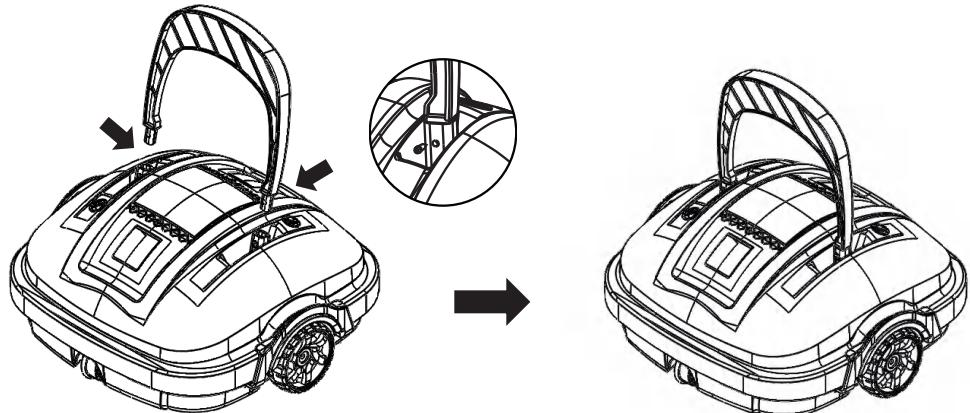
Примечание: направление установки двух винтов противоположное.
