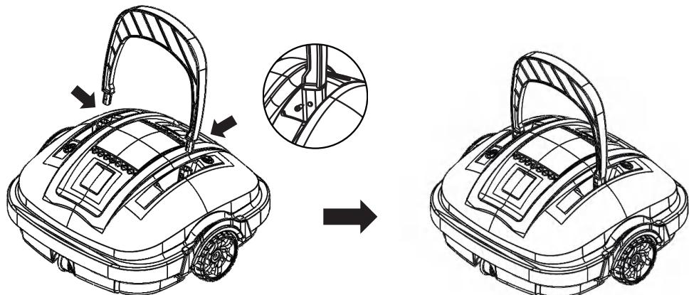
Nota: A direção de instalação de 2 parafusos é oposta.
