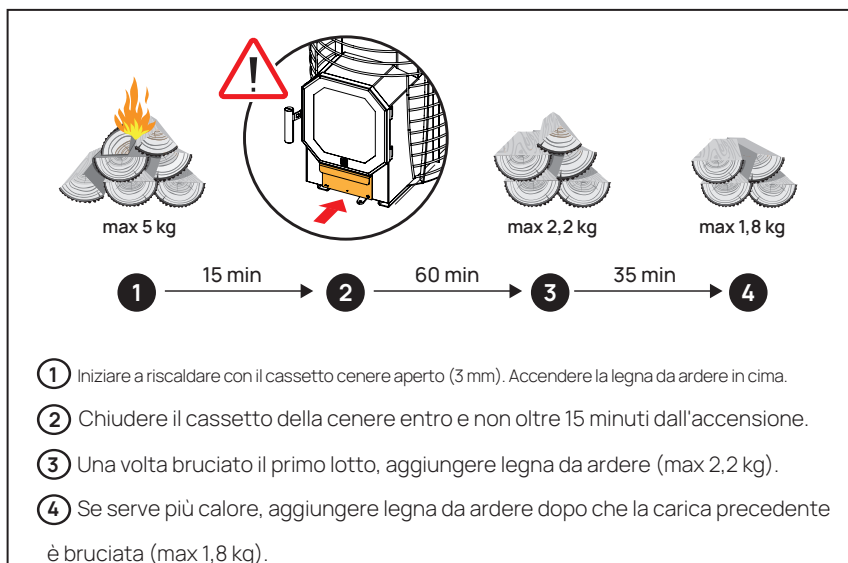
Figura 16. Avvio del riscaldamento HIVE Flow e aggiunta della partita di legna da ardere.
