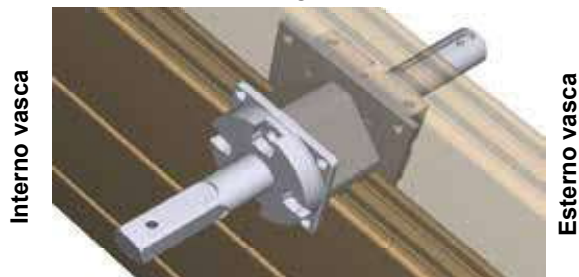
Figura 40 – Montaggio dell'albero della copertura automatica
