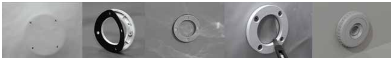
Figura 36 – Montaggio della flangia sulla mandata
