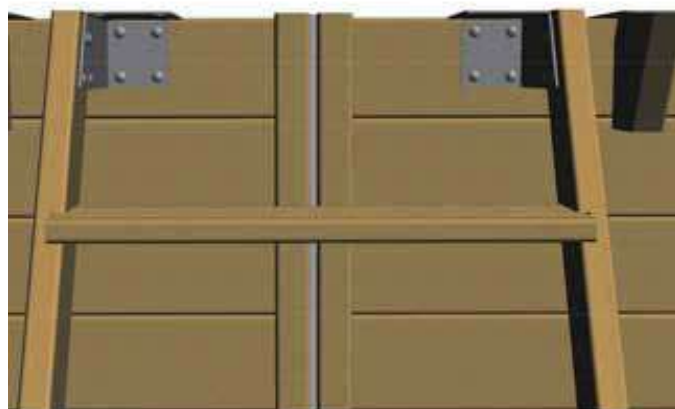
Figura 18 – Fissaggio della scala esterna sulla vasca
