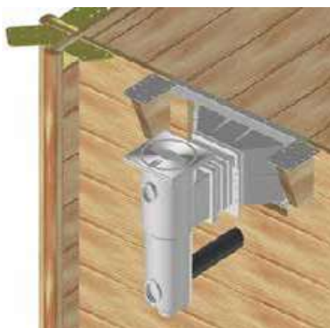
Figura 25 – Montaggio della staffa per skimmer
