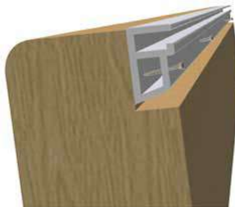
Figura 31 – Posa del profilo di bloccaggio
