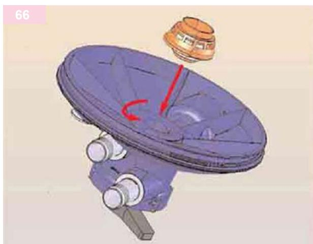
Inserire il diffusore nel coperchio e bloccarlo ruotandolo in senso **ANTIORARIO**.
