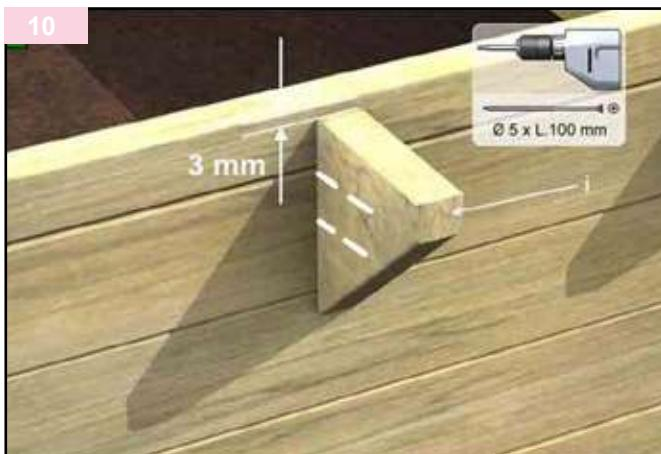
Le mensole sono destinate a sostenere il bordo perimetrale che verrà posizionato dopo il riempimento della vasca. Dopo aver preforato le pareti dall'interno della piscina, fissate ogni mensola (tipo I) utilizzando 2 viti (5x100 mm - sacchetto I), avendo cura di posizionarle 3 mm al di sotto della parte superiore della struttura. Dopo l'avvitamento, assicuratevi di eliminare ogni eventuale scheggia.
