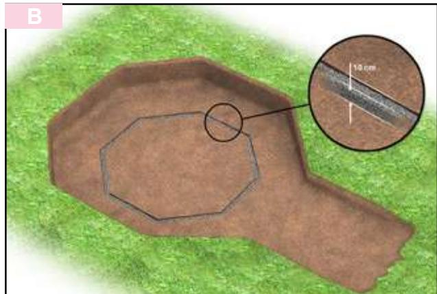
Una volta realizzato lo scavo, riempitelo per circa 10 cm con ghiaia di piccola granulometria. Al fine di evitare un cedimento che si ripercuoterebbe sulla struttura della piscina, assicuratevi di compattarlo bene. Completate il riempimento con sabbia compattata. Lo scavo riempito deve essere allo stesso livello del suolo.
