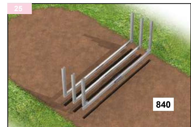
Una volta assemblati i supporti (basamenti), inseriteli nelle tracce e bloccateli utilizzando, se necessario, della sabbia umida compattata. Durante questa operazione, assicuratevi di controllare il livello, battuta.amento e il parallelismo. Riempite le tracce utilizzando ulteriore sabbia umida costipata (battuta).
