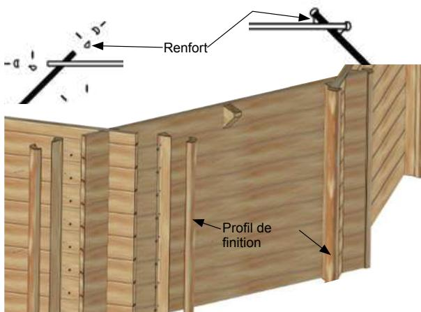
**Per fissare il rinforzo dall'esterno:** Posizionare le viti a 100 mm dall'angolo. Inserire una vite per ogni asse .
