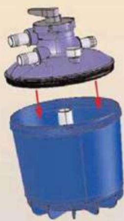
Verificare la pulizia dell'interno del serbatoio nella sua parte superiore.
