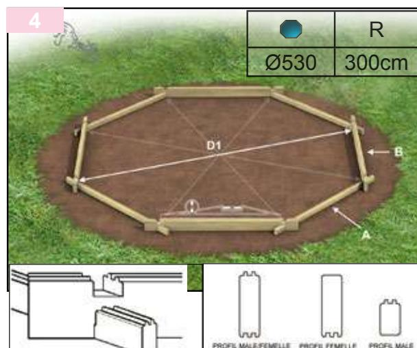
Incastrate le 4 mezze pareti di tipo A (lisce sul lato inferiore) con 4 pareti maschio/femmina (tipo B), con le scanalature rivolte verso il basso e le parti maschio (doppia linguetta) orientate verso l'alto (vedere il dettaglio sopra).
