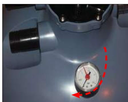
Orientare il manometro e posizionarlo nel suo alloggiamento.
