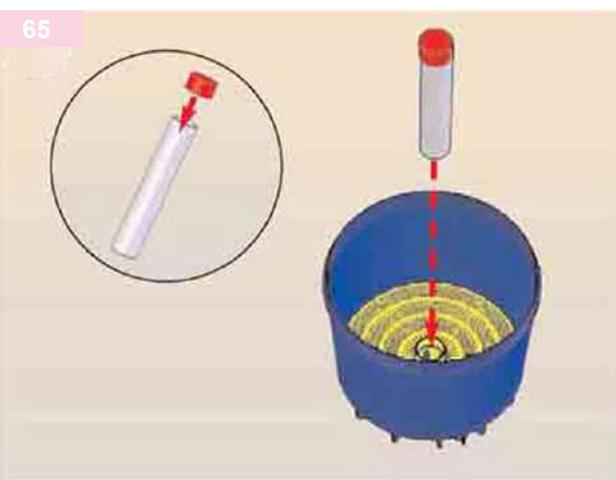
Coprire il tubo diffusore con il tappo di protezione e inserirlo nel foro al centro del fondo forato.
