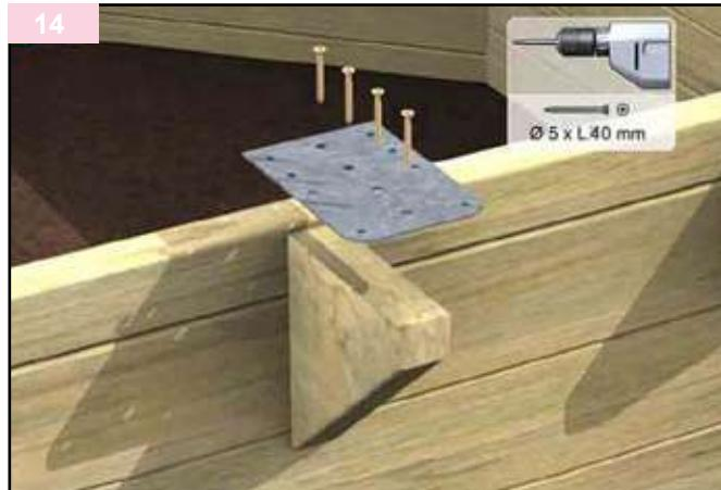
Fissate su ogni mensola una piastra (kit mensola) destinata al posizionamento del bordo perimetrale. Assicuratevi che ogni piastra sia posizionata correttamente a filo con la parte superiore delle pareti.
