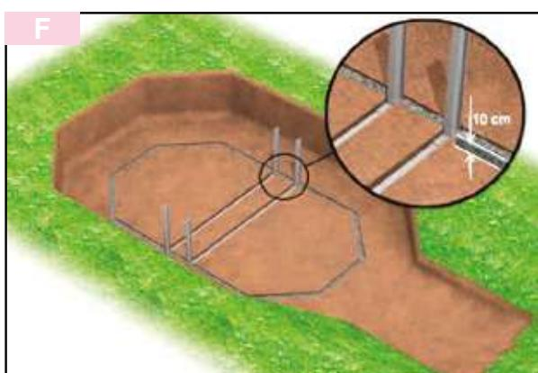
Una volta realizzata la trincea, riempitela per circa 10 cm con ghiaia di piccola granulometria. Al fine di evitare un cedimento (assestamento) che si ripercuoterebbe sulla struttura della piscina, assicuratevi di compattarla bene. Completate il riempimento con sabbia compattata. Lo scavo riempito deve essere allo stesso livello del suolo.
