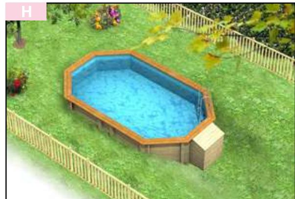
Effettuate il rinfianco (o riempimento) attorno alla vasca evitando bruschi apporti di terra, che potrebbero causare deformazioni alla struttura.
