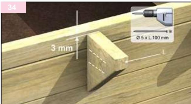
Le mensole sono destinate a sostenere il bordo (che sarà posizionato dopo il riempimento della vasca). Dopo aver preforato le pareti, fissare ogni mensola (tipo L) dall'interno della piscina utilizzando 2 viti (sacchetto L, viti 5x100 mm), avendo cura di posizionarle 3 mm al di sotto della parte superiore della struttura. Assicurarsi di controllare che ogni mensola sia a piombo.
