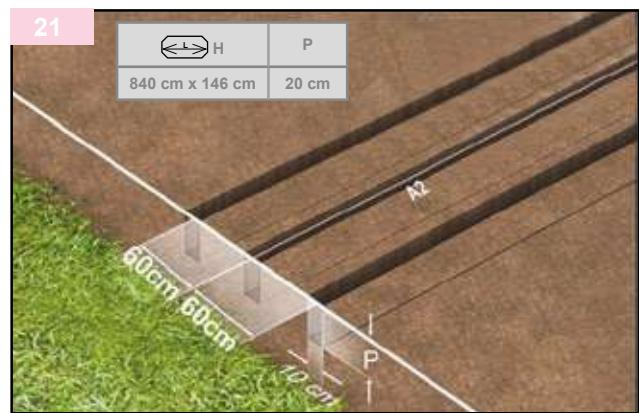
Per l'installazione dei supporti (basamenti), dovete scavare delle tracce (scavi a canaletta), assicurandovi che siano perfettamente parallele tra loro e rispetto all'asse A2. Il numero di tracce varia a seconda del modello di piscina; fate quindi riferimento alle illustrazioni corrispondenti al vostro modello. Le tracce devono essere regolari e dimensionate correttamente per consentire l'inserimento dei supporti e il loro corretto posizionamento.
