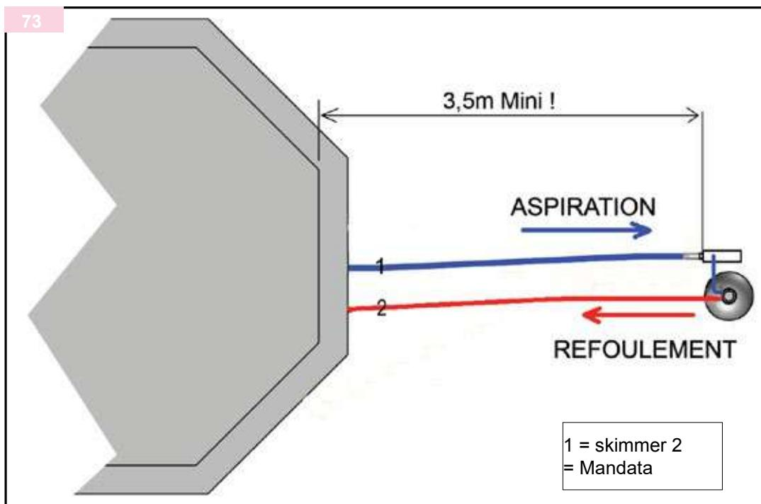
Effettuare, seguendo lo schema sopra riportato, il collegamento dei tubi tra i condotti rigidi e il gruppo di filtrazione. La bobina di tubo fornita nel kit di filtrazione della piscina è dimensionata per un'installazione di base del gruppo (ovvero senza locale tecnico chiuso a chiave) a 3,5 m dalla vasca (distanza minima della pompa rispetto alla vasca secondo la norma elettrica C15-100).
