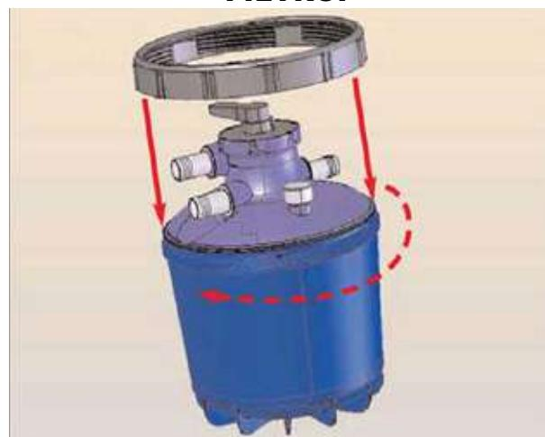
**Bloccare il coperchio sul serbatoio utilizzando l'anello di serraggio (V).**
