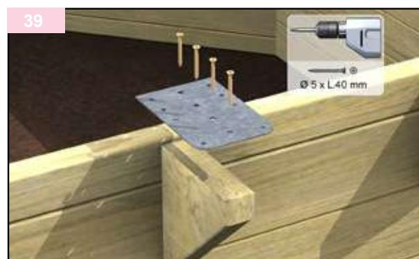
Fissare su ogni mensola una piastra (kit mensola) destinata al posizionamento del bordo. Assicurarsi che ogni piastra sia posizionata correttamente a filo con la parte superiore delle pareti. Effettuare una svasatura sui fori delle piastre prima dell'avvitamento.
