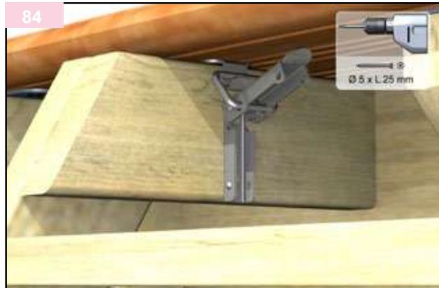
La scala in legno è dotata di due chiusure a leva che ne consentono un bloccaggio efficace. Le parti a leva vanno fissate sui montanti della scala, mentre i ganci vanno installati sotto il bordo vasca (troverete questi componenti nel sacchetto K). È necessario studiare il funzionamento congiunto di questi due pezzi per comprenderne il meccanismo e valutare la corsa necessaria a garantire un bloccaggio sicuro una volta che la scala è in posizione.
