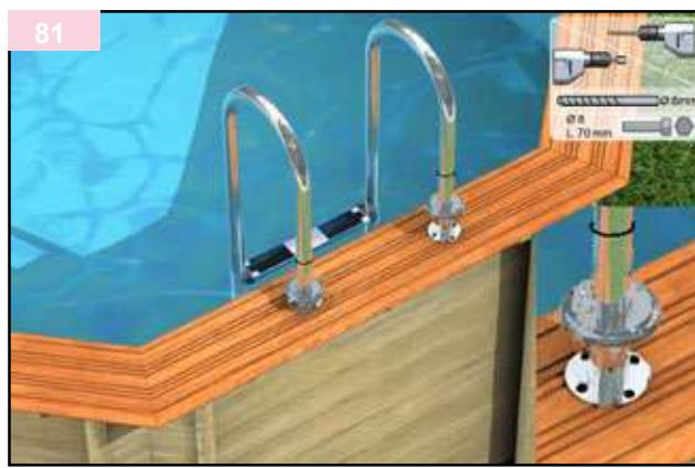
Una volta stabilita la posizione, regolate il posizionamento della scala assicurandovi in particolare che sia verticale e che i paracolpi siano premuti saldamente contro la parete interna. Segnate i punti in cui praticare i fori. Rimuovete la scala e procedete con i fori per i bulloni di fissaggio inclusi nella confezione della scala.
