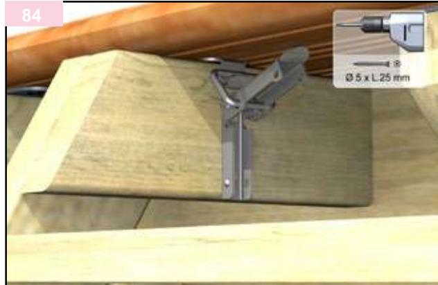
La scala in legno è dotata di due chiusure a leva che ne consentono un bloccaggio efficace. Le parti a leva vanno fissate sui montanti della scala, mentre i ganci vanno installati sotto il bordo vasca (troverete questi componenti nel sacchetto K). È necessario studiare il funzionamento congiunto di questi due pezzi per comprenderne il meccanismo e valutare la corsa necessaria a garantire un bloccaggio sicuro una volta che la scala è in posizione.
