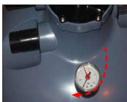
Orientare il manometro e posizionarlo nel suo alloggiamento.
