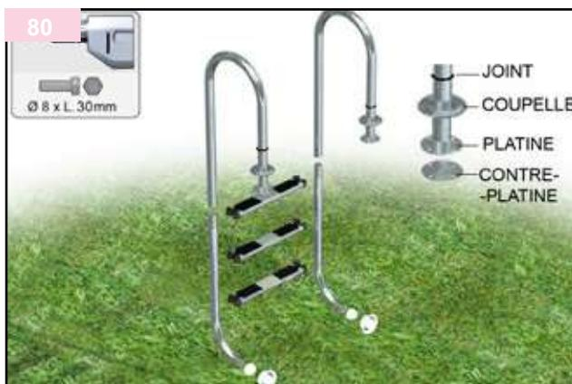
Montate la scala in acciaio inossidabile facendo riferimento alle istruzioni fornite nella confezione. Inserite le piastre e gli elementi in gomma.
