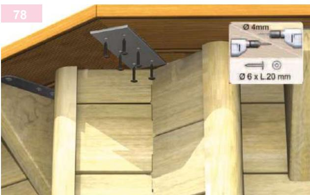
Vi rimane da fissare sotto ogni angolo del bordo le 8 piastre metalliche utilizzando le viti per cardini (sacchetto G).
