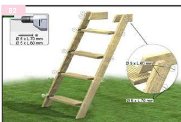
Troverete i montanti laterali e i gradini della scala all'interno del kit legno della piscina. Assemblate la scala utilizzando le viti in acciaio inox (sacchetto K).
