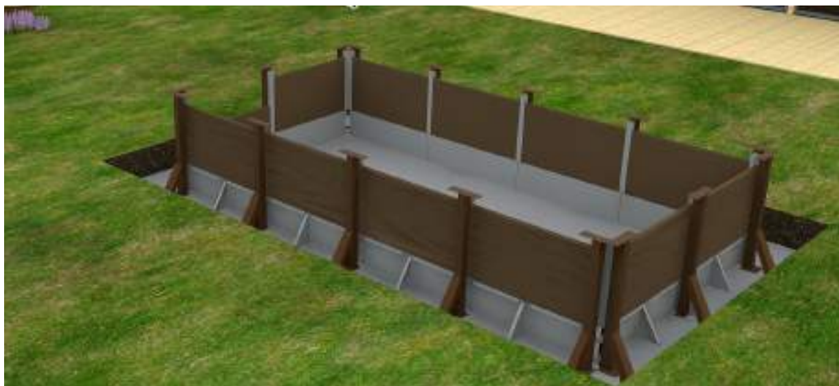
Installazione della trave n. 2 fino alla 6a fila.
