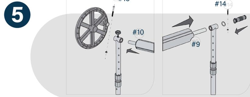
Avvitare il pezzo del freno (#5) nel supporto corrispondente (#3). Inserire il tubo con la manopola (#10) nel supporto (#1), quindi posizionare il volante (#4) unendolo con la vite (#15). Inserire l'estremità opposta con la manopola (#9) nel supporto (#4), posizionare la maniglia (#11) all'estremità della manopola, fissandola con la vite (#13).
