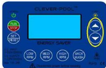
Premere il pulsante SET/RESET per passare dalle ore ai minuti e dall'ora di avvio a quella di arresto.
