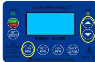
Premere il pulsante RUN/STOP per passare alla modalità di funzionamento, in modo da avviare la pompa. Quando il timer del clorinatori si spegne, il S4S memorizza la velocità e la riprende alla riaccensione.
