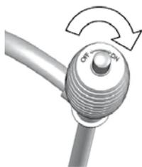
Ruotare in senso orario (posizione ON) la manopola posta nella parte superiore.
