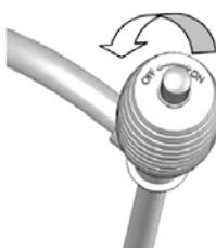
Finito di riempire il serbatoio della stufa (una volta raggiunto il livello MAX segnalato con una riga), posizionare la manopola sulla posizione off, ruotando la stessa in senso antiorario. In questo modo si svuota la pompa a sifone.
