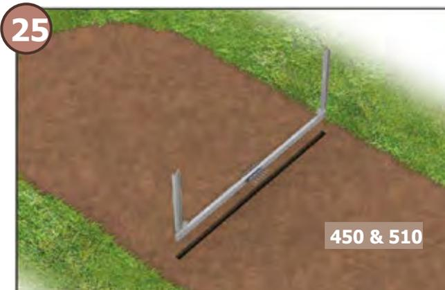
Una volta che l'intelaiatura sarà stata assemblata, posarla negli scavi e fissarli in posizione usando sabbia bagnata compatta se necessario. Durante questa operazione, controllare che l'intelaiatura sia a livello, dritta, allineata e parallela. Riempire gli scavi usando sabbia bagnata compatta.
