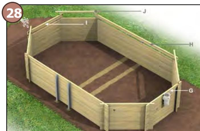
A questo punto, montare lo skimmer nella lamina lavorata (F). Far scorrere la scanalatura superiore dello skimmer (G) sopra la stecca F e continuare attorno la piscina, montando 2 stecche di tipo H, 1 stecca di tipo I e 4 mezze stecche di tipo J in posizione come mostrato.
