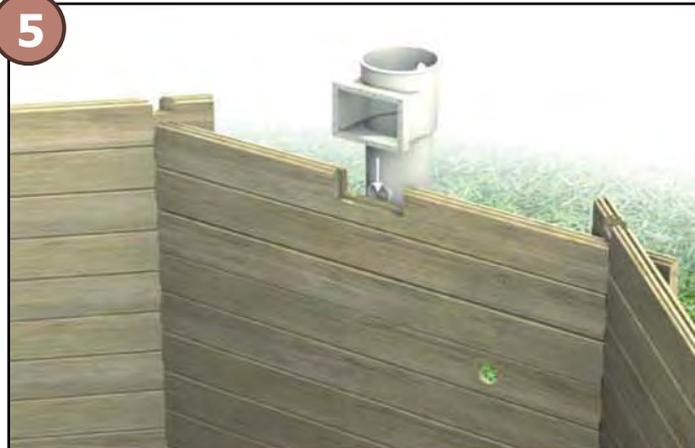
A questo punto, montare lo skimmer o l'unità di filtrazione autonoma sul fondo della stecca dello skimmer (tipo D).
