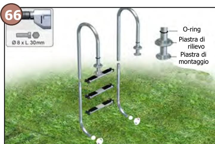
Assemblare le varie parti della scaletta in riferimento alle istruzioni d'installazione fornite. Durante il montaggio del corrimano, non dimenticare le due guarnizioni in gomma che verranno usato per tenere in posizione le piastre di rilievo di decorazione.
