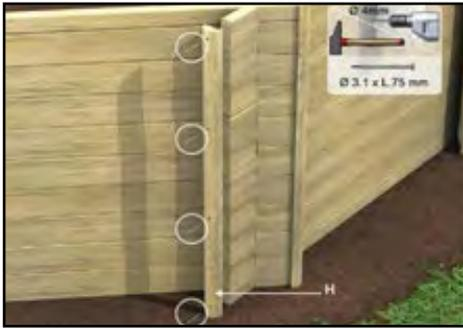
Montare il profilo decorativo (tipo H) alla fine di ciascuna parete usando i chiodi (3.1x75mm) inseriti attraverso fori equamente separati e pre-forati attorno gli assi del profilo.
