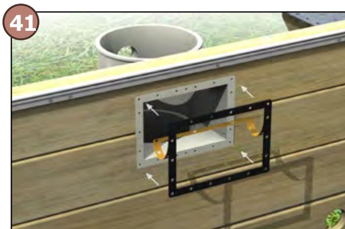
Prima di adattare il liner, incollare una delle 2 guarnizioni auto-adesive intorno la bocchetta dello skimmer o all'unità di filtrazione.
