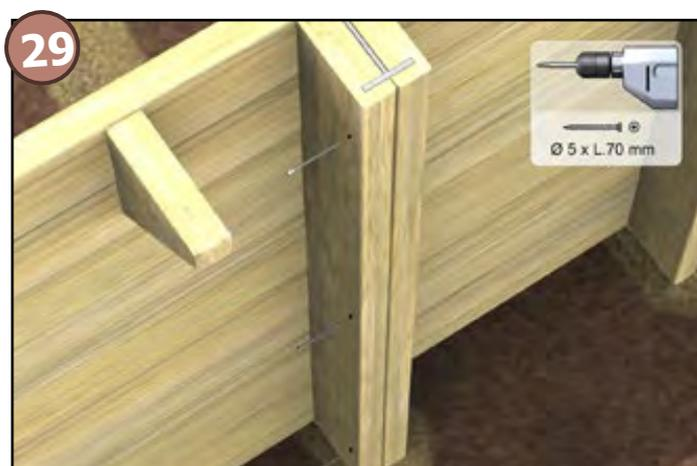
Lavorando dall'interno, allacciare i montanti verticali dell'intelaiatura (pre-forati) nelle pareti di legno usando viti 6x30 mm del sacchetto S. Controllare la loro verticalità. Posizionare due profili decorativi (Q) su ciascun lato di ciascun paletto e fissarli insieme usando 3 viti 5x70 (sacchetto S) come mostrato.
