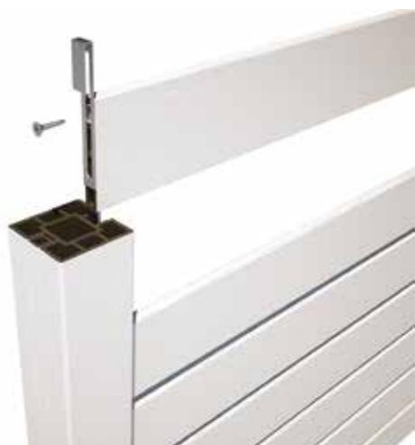
Posizionare il kit di chiusura nella parte superiore e fissare con la vite nell'anima di rinforzo.
