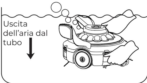
1. Accendere l'interruttore, l'indicatore si accende, inserire il robot orizzontalmente nella piscina e attendere che il robot si abbassi liberamente fino al fondo della piscina; sono necessari circa 20-30 secondi per far uscire l'aria.
