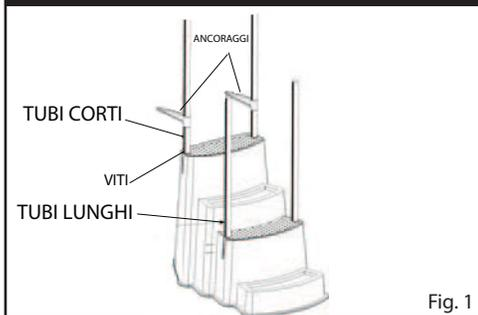
1. Posiziona i tubi sui lati della scala (i tubi corti nella parte superiore) e allineali con gli appositi fori. Fissali con gli 8 bulloni 2 1/2", asole e dadi. Non stringere i bulloni in questo momento. Far scorrere gli ancoraggi lungo i tubi corti (fig. 1)
