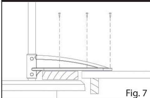
7. Se la pavimentazione è più in alto del bordo della piscina, gli ancoraggi vanno sistemati fissati alla pavimentazione inserendo uno spessore\* che allinei il bordo e la pavimentazione (fig. 7). Assicurati che lo spessore e gli ancoraggi siano fissati correttamente.
