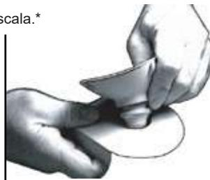
**A1)** Inserire metà della parte inferiore della ventosa nel foro con un angolo di 45°
