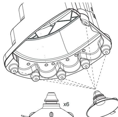
**B1)** Inserire metà della parte inferiore della ventosa nel foro con un angolo di 45°
