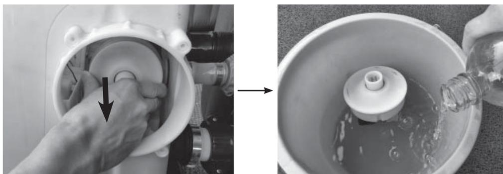
6. Rimuovere la cella elettrolitica e risciacquare la piastra in titanio con acqua corrente. Attenzione: tenere il contenitore della cella elettrolitica completamente asciutto e assicurarsi che non entri in contatto con l'acqua o l'aceto.
