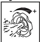
È possibile regolare la quantità e la pressione di acqua in uscita dagli ugelli idromassaggio ruotando il bordo dell'ugello idromassaggio in senso orario (massima uscita dell'acqua), antiorario (bassa uscita di acqua) o qualsiasi posizione intermedia. La chiusura di uno o 2 ugelli idromassaggio devierà la pressione dell'acqua verso gli altri ugelli idromassaggio.
